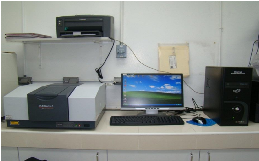
Figura N°31. Aparato de espectrofotetría infrarrojo de Fourier con el ordenador que contiene el programa IR-RESOLUTION, en el laboratorio fisicoquímico de aguas.
