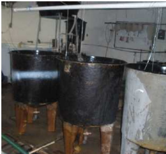
figura. 9 Incubadoras de nauplios de artemia, en la parte superior tubería de aireación.
