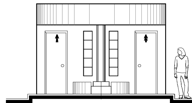
ELEVACION SUR DE BATERIA SANITARIA 2 ESC.1:75
