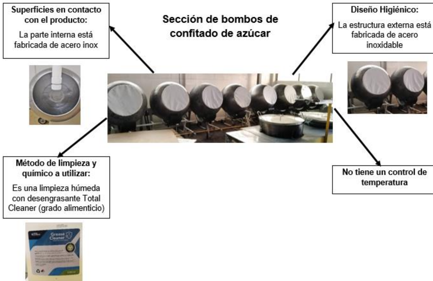
Figura 70. Explosión de partes de la sección de bombos de confitado de azúcar.
