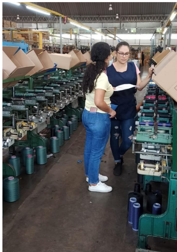
Anexo 4 Operario de enconado sin alfombras antifatiga
