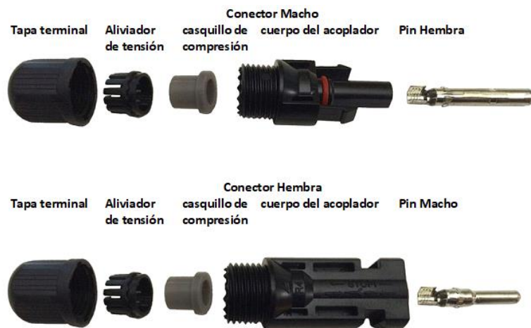
Figura 56. Vista de armado para conectores MC4.
