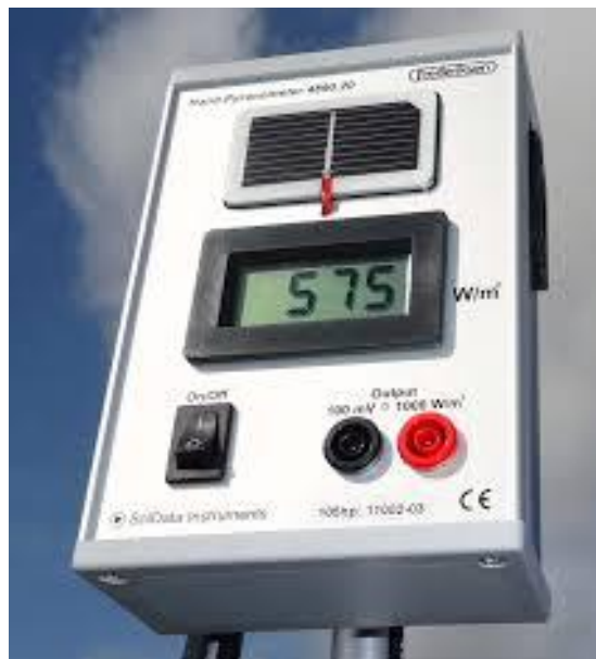
Figura 63. Piranómetro de mano Frederiksen 4890.2
