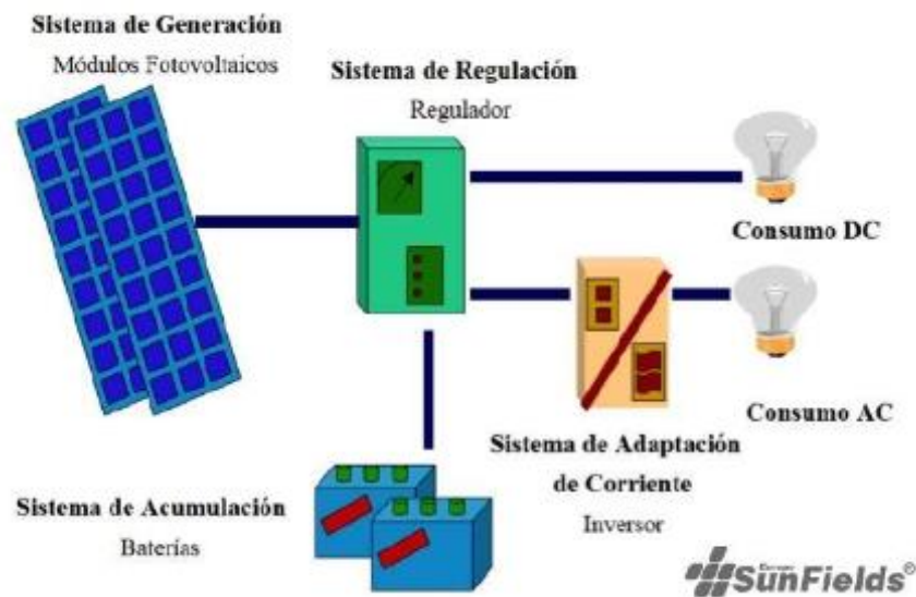
Figura 37. Sistema fotovoltaico aislado (Off Grid).
