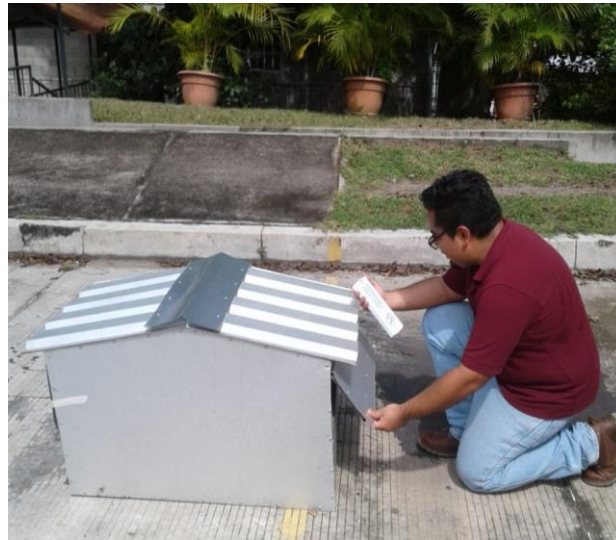
Fig. A5. Mediciones de temperatura en maqueta experimental antes y después de aplicación del tratamiento.
