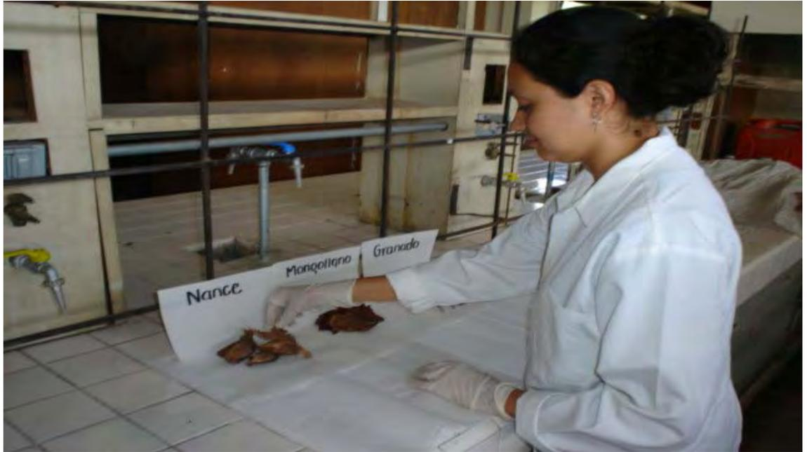
Figura N° 15. Preparación de las muestras antes de ser molidas para evitar una contaminación.
