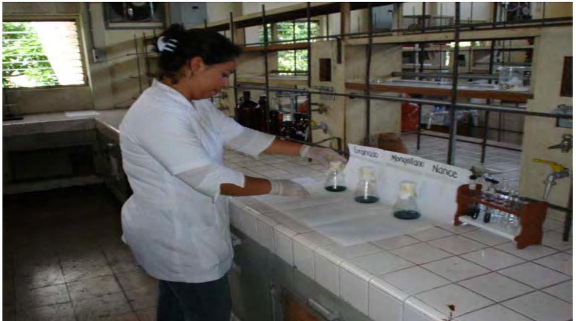
Figura N° 16. Preparación de las muestras antes de valorar con  $\text{KMnO}_4$ .
