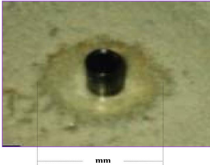
Figura No. 4 Medición de la Concentración Mínima Inhibitoria
