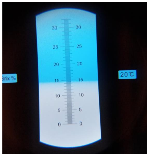
Figura 10. Medición de grados Brix de pulpa de naranja.
