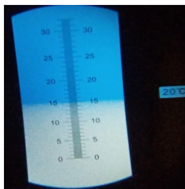
Figura 6. Medición de grados Brix en pulpa de piña.
