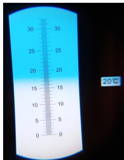
Figura 22. Medición de grados Brix en mucílago de cacao.
