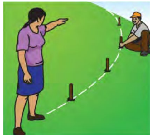
Figura 16. Alineado de estacas
