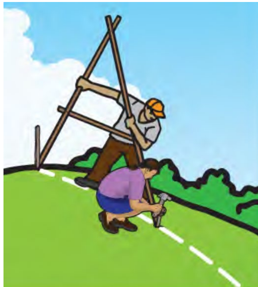
Figura 13. Movimiento del nivel A para colocar estacas
