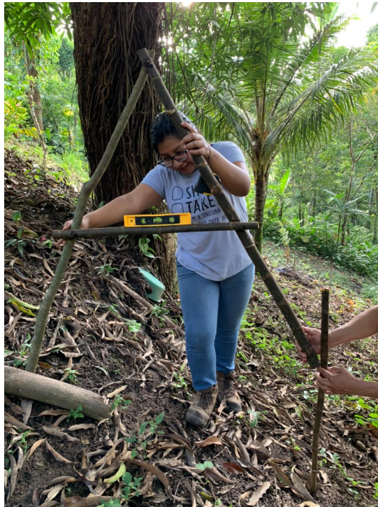
Anexo 8. Construcción del nivel Tipo A.
