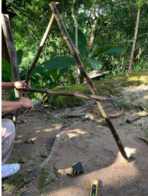
Anexo 7. Determinación de pendiente con la ayuda del nivel tipo A.
