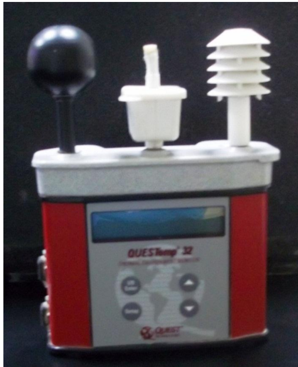
Figura N° 36. Monitor de estrés térmico Questemp° 32, marca Quest, serie 7901264, serial TPG 100013.
