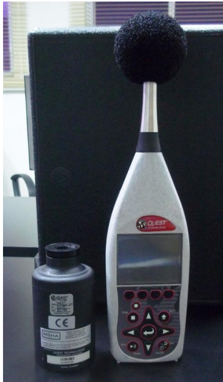
Figura N° 34. Sonómetro Soundpro™, marca 3M, modelo SE & DL, serial BHJ040018 y un calibrador acústico QC-10 CALIBRATOR, marca 3M, modelo QC-10/QC-20, serial QIJ040248.
