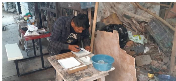
Figura 15. Práctica, formulación de diferentes tipos de pastas (yeso calcinado, cemento blanco, chispa y polvo de mármol), para aplicación final. Fotografía tomada por: Carlos Cubias.
