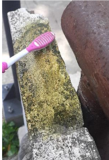
Figura 13. Relieve N°1, Prueba de lavado, utilizando mezcla de alcohol y agua, para tratar las causas del deterioro de carácter biológico y químico. Fotografía tomada por: Carlos Cubias.
