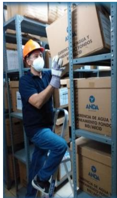
Fotografía 6: Escalera tipo tijera de 3 peldaños de aluminio de 1.20 metros de alto. Fabrica bajo norma OSHA.
