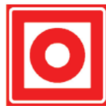
Pulsador de alarma
