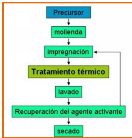
Figura 4.2 Diagrama del proceso de Activación Química para la producción de Carbón Activado. 17
