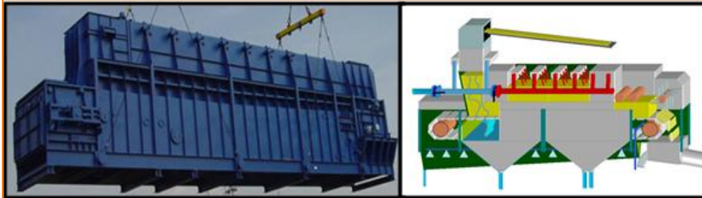
Figura 6.11 Extrator tipo Smet industrial y su esquema interno
