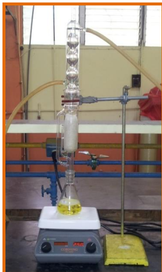
Figura 5.1 Montaje Experimental del equipo Soxhlet para la extracción de aceite de la Semilla de Moringa oleífera .
