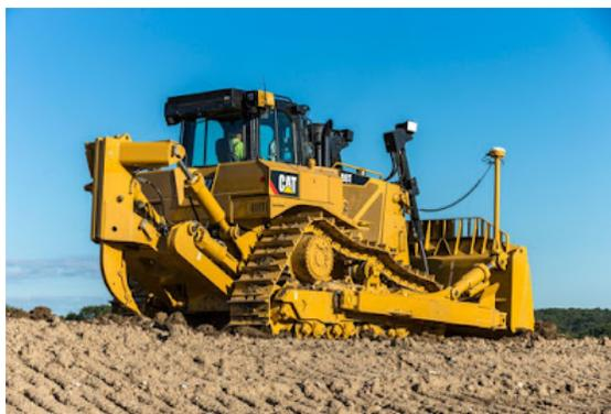
Figura 50: Tractor de Orugas con Bulldozer.
