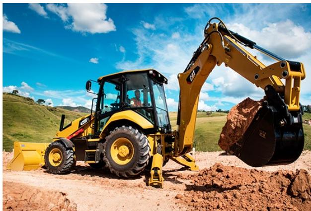
Figura 53: Retroexcavadora.
