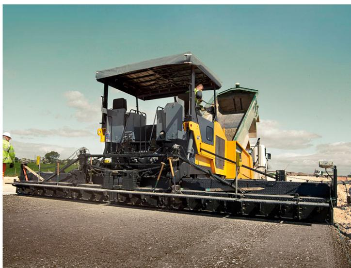
*Figura 56: Pavimentadora de asfalto.*
