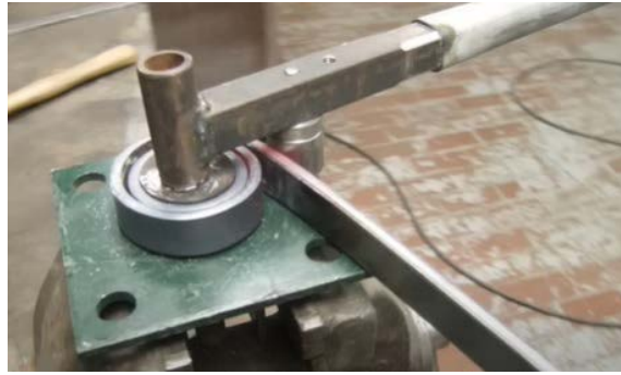
Fig. 3.14. Conformado de las primeras espiras haciendo uso de la herramienta [17].
