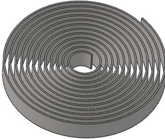
Fig. 2.10. Ilustración del resorte espiral que se emplea en la centrífuga.
