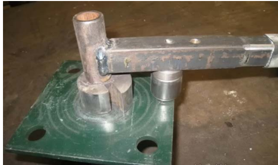
Fig. 3.13. Herramienta artesanal para conformar el resorte [17].
