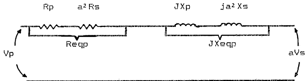
Figura 2.14. Circuito equivalente, despreciando la rama de magnetización.
