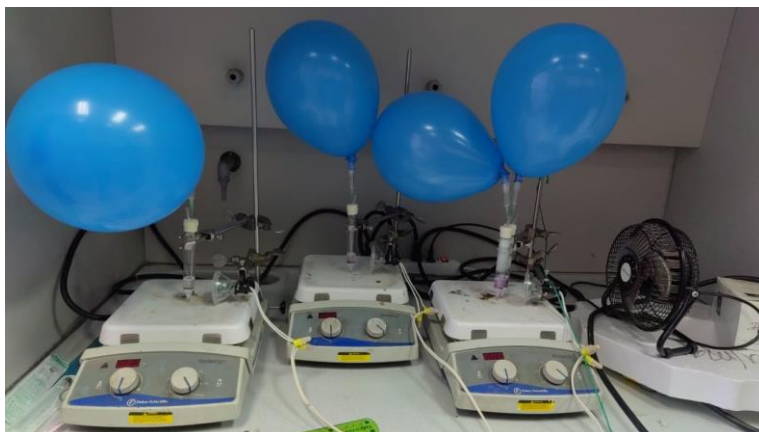
Figura N°39. Fotoreactor utilizado para la reacción sin irradiación (fuente: elaboración propia).
