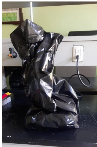
Figura N°44. Sistema a oscuras para la síntesis de AgNPs (fuente: elaboración propia).
