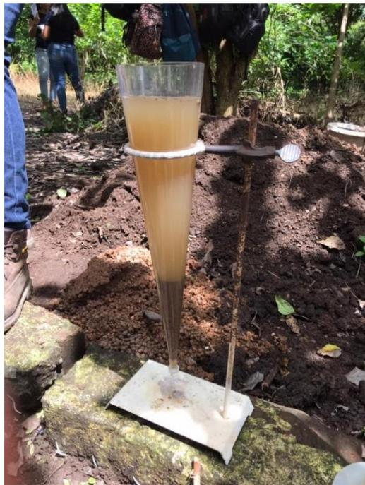
**Figura 17. Uso del cono Imhoff para determinar sólidos sedimentables. 2022**
