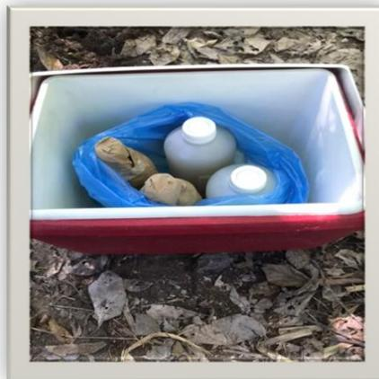
**Anexo A7. Toma de muestras para análisis de laboratorio de Coliformes Fecales y DBO5**
