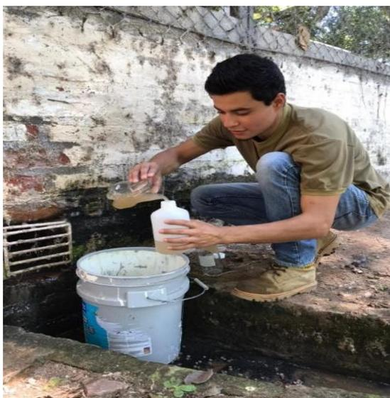
**Figura 18. Toma de muestras para análisis de DBO<sub>5</sub> y Coliformes Fecales. 2022.**
