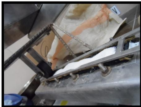
5° Esparcir arena Ottawa a 80°C en toda la pastilla para determinar la adhesión, y comenzar el ensayo
