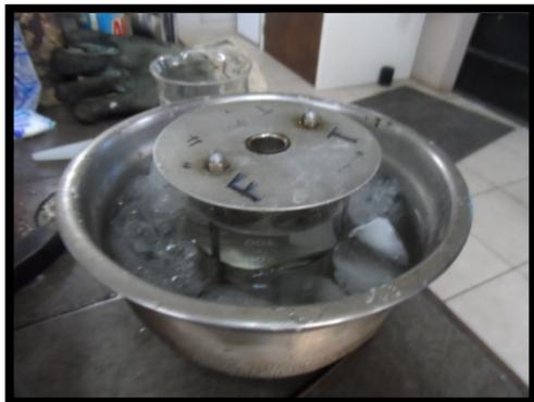
3° Llevar el agua en la que se ensayan las muestras a una temperatura inicial de 4° C
