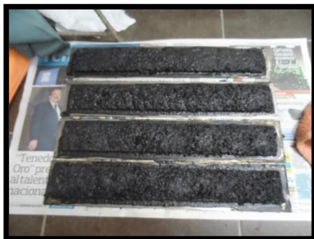
3° Dejar secar al horno a 60°C las pastillas hasta obtener peso constante (24 h)
