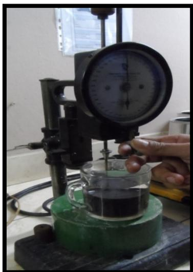
3° Colocar la muestra en el penetrometro y ajustar la aguja lo más al centro posible para realizar en ensayo
