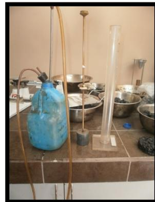
**Fotografía 4.4**Equipo utilizado para ensayo Equivalente de arena
