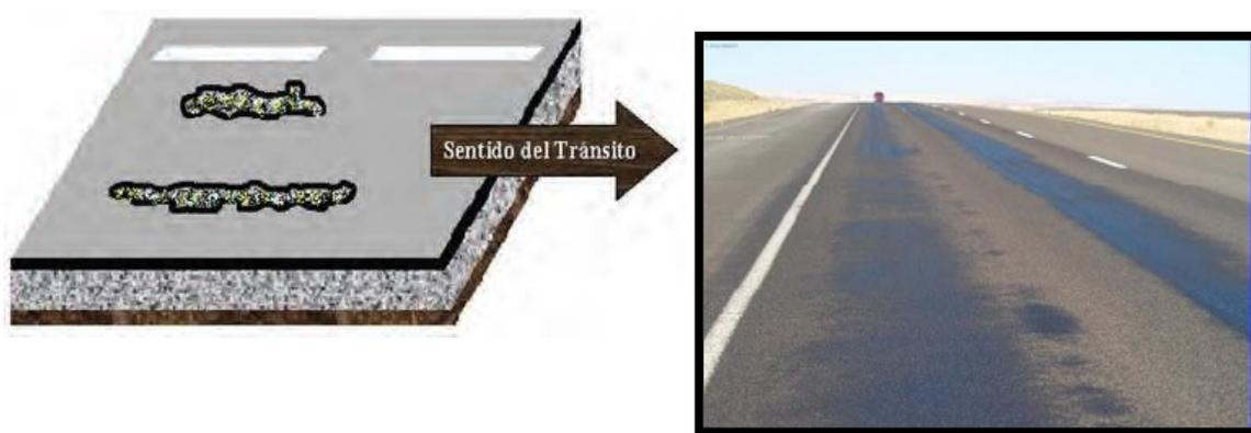
Figura 2.6 Presencia de Exudación en Pavimentos Flexibles
