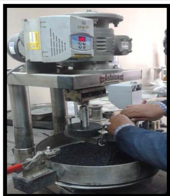
6° Colocar la pastilla en la pista de ensayo del equipo, luego de 1h de inmersión, cubrir con suficiente agua la pastilla en la pista de ensayo
