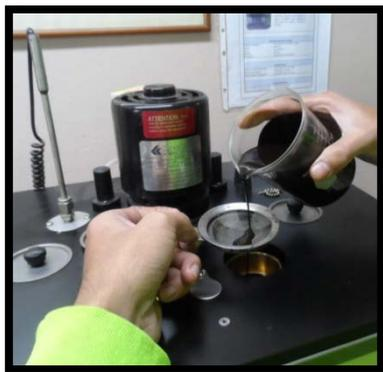
3° Depositar la muestra en el viscosímetro
