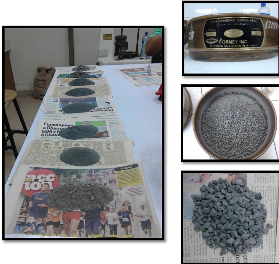
Fotografía 4.3 Fracciones de material ya tamizados
