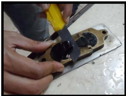
4° Enrasar los moldes con la muestra y devolver a inmersión por 1.5 horas.
