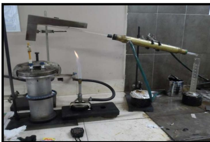
Fotografía 4.9 Equipo utilizado para ensayo de Destilación
