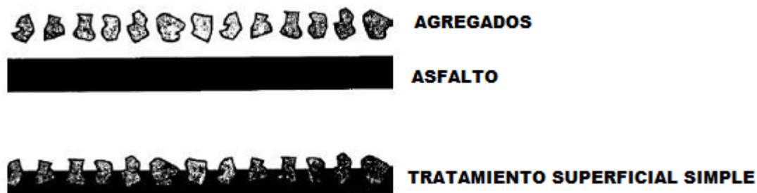
Figura 3.2 Esquema representativo de un Tratamiento Superficial Simple
