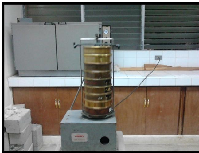
**Fotografía 4.2 Proceso de tamizado en agitador mecánico**
