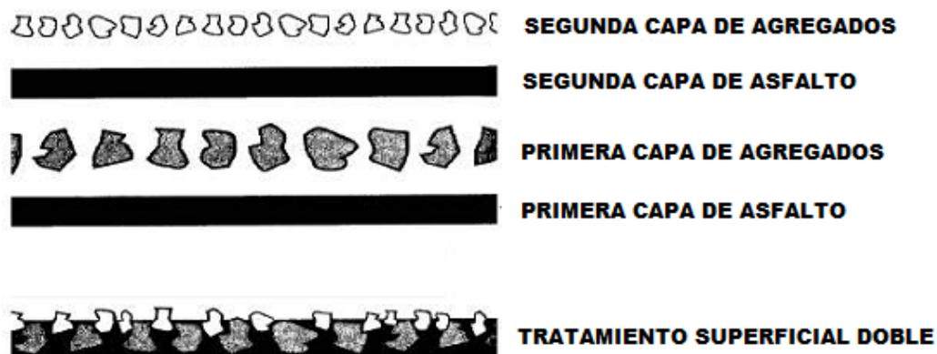
Figura 3.3 Esquema representativo de un Tratamiento Superficial Doble
