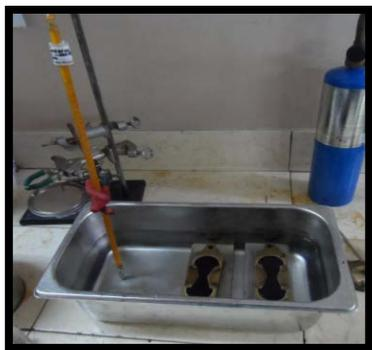
3° Sumergir la muestra en agua a 25° C por 30 min.
