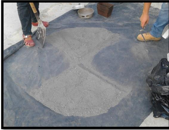
**Fotografía 4.1 Reducción de muestra a tamaño de ensayo**
