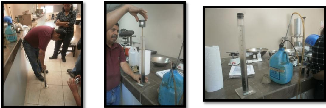
**Fotografía 4.7 Irrigación de probeta y colocación del conjunto disco, varilla, sobrepeso**
