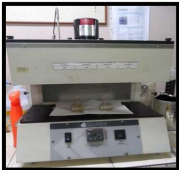
1° Viscosímetro Sabolt Furol y recipientes para determinar la viscosidad
