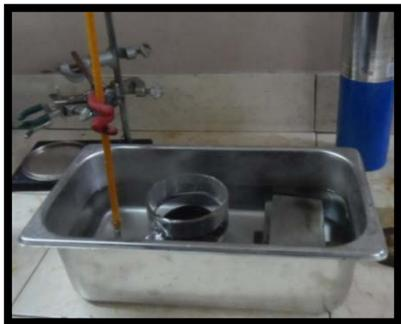
2° Llevar la muestra a 25° C como temperatura de ensayo
