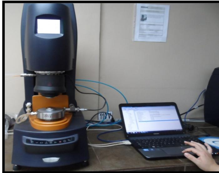
Figura 4.6 Reómetro de corte dinámico
