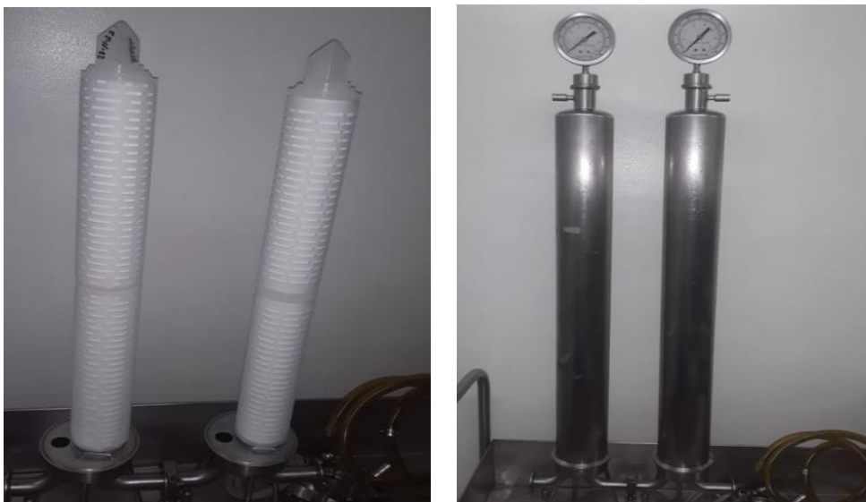
Figura N°19 Y N°20. Filtros esterilizantes y carcasas respectivamente.
