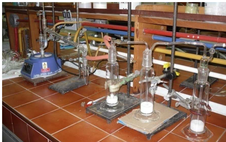
Figura 4-2. Sistema de destilación a presión reducida.
