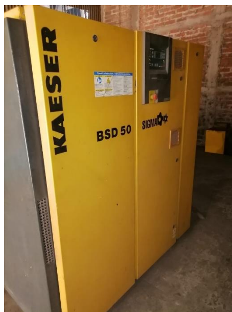
Figura 36. Compresor Kaeser BSD 50
