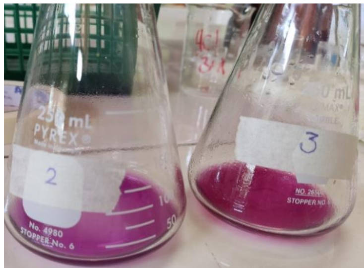
Figura N°. 4 Demostración de viraje de color al realizar una valoración complejométrica con EDTA 0.1 M para Calcio, usando Murexida como indicador (a la derecha se observa la muestra inicial a la izquierda se muestra el punto final).
