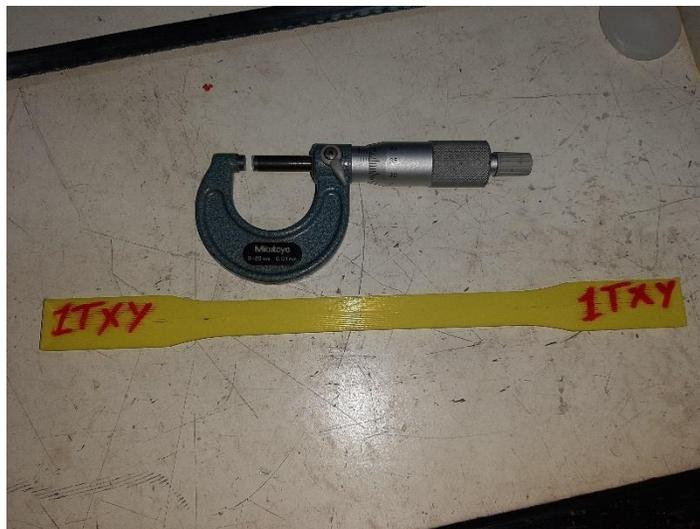
Figura 40 Toma de dimensiones y categorización de especímenes de ensayo de tracción.
