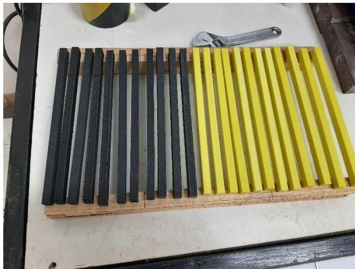
Figura 44 Exposición al ambiente de los especímenes de ensayo de flexión, para el acondicionamiento al ambiente del laboratorio.
