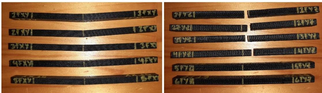
Figura 93 Fracturas de los especímenes de flexión fabricados con PATHC CF15.
