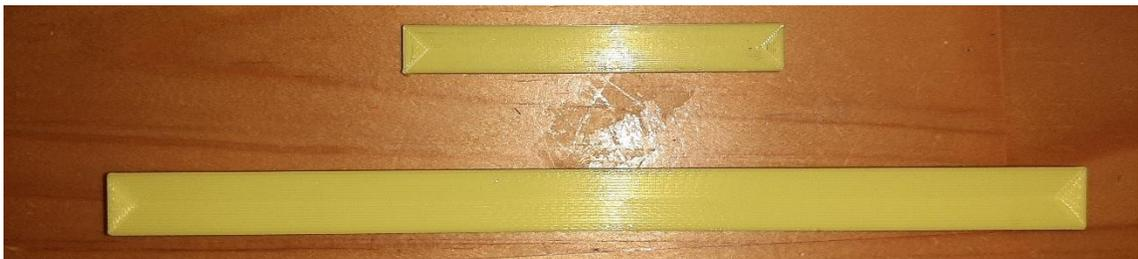
Figura 26 Comparación de las probetas impresas con las dimensiones recomendadas por la ASTM D790 (probeta de la parte superior de la figura) y con las dimensiones ajustadas a las consideraciones hechas para el diseño (probeta de la parte inferior de la figura).
