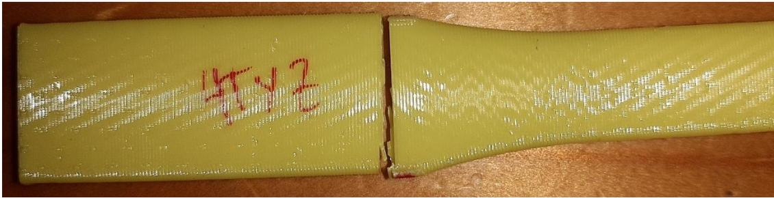
Figura 88 Fractura iniciada posiblemente por agujeros creados por burbujas de vapor en el material.
