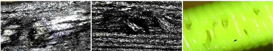
Figura 38 Defectos en el material impreso, visto a través de un microscopio digital a 1600X.
