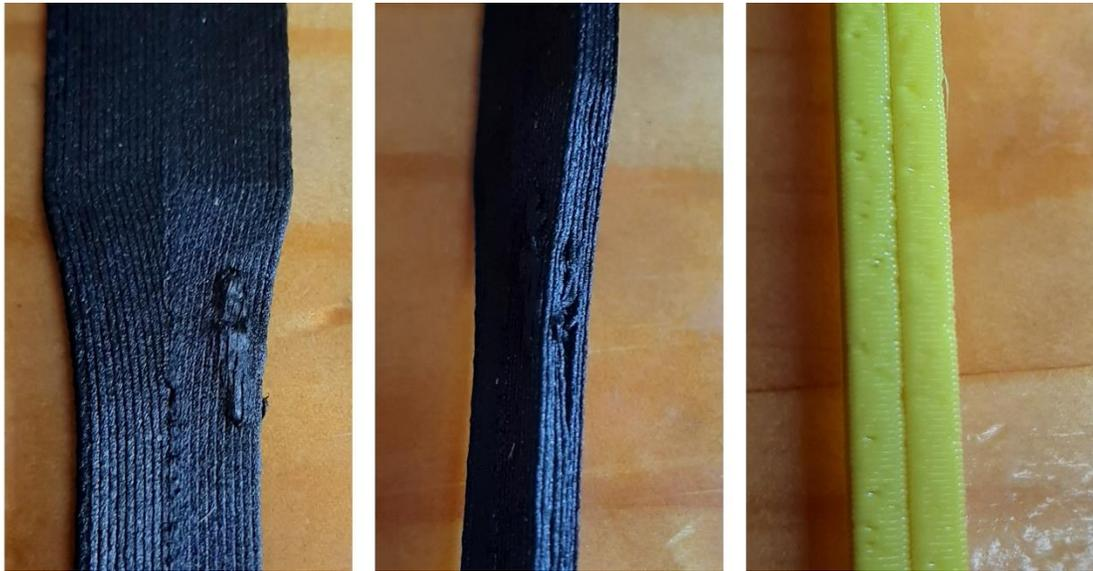
Figura 37 Defectos visibles en el material impreso.
