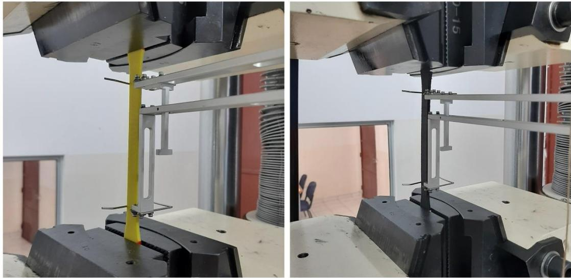
Figura 41 Probetas de tensión acopladas a la máquina de ensayo con un extensómetro: A la izquierda una probeta fabricada en PLA y a la derecha una fabricada en PAHT CF15.
