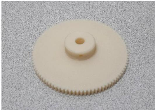
Figura 15 Engrane impreso en 3D utilizando ABS.
