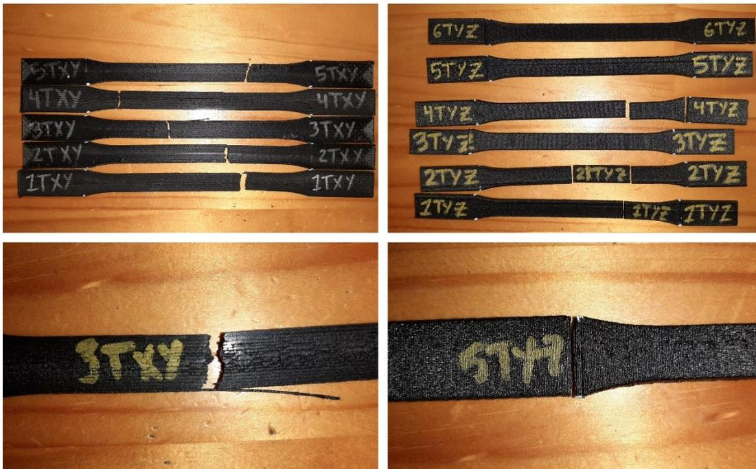
Figura 90 Fracturas del ensayo de tensión de los especímenes fabricados con PAHT CF15.
