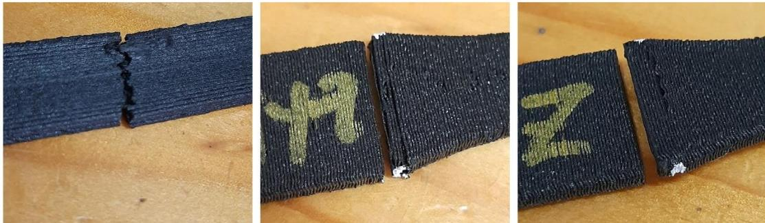
Figura 91 Fracturas relacionadas con defectos en el material, en los especímenes de tensión fabricados con PAHT CF15.
