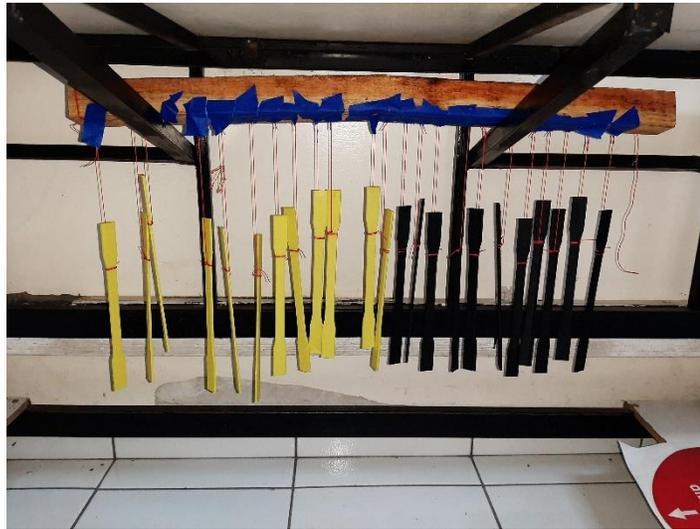
Figura 39 Exposición al ambiente de los especímenes de ensayo de tracción, para el acondicionamiento al ambiente del laboratorio.
