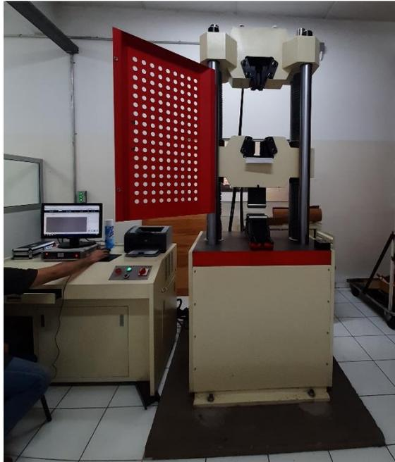
Figura 21 Máquina universal de ensayos de materiales: CMS Metrology WAW-1000D, en el Laboratorio de materiales de la UDB .
