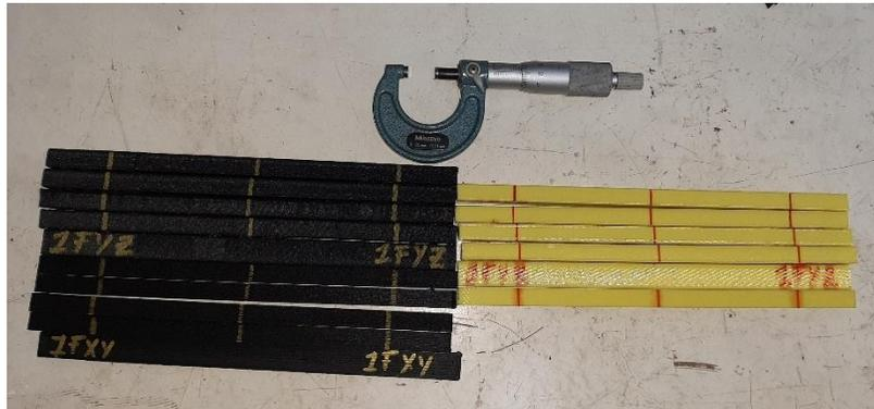
Figura 45 Toma de dimensiones y categorización de especímenes de ensayo de flexión.
