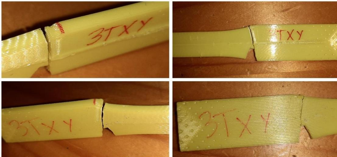
Figura 89 Fractura en espécimen 3TXY originada por un defecto de impresión llamado costura.
