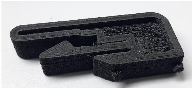
Figura 16 Pieza impresa utilizando PAHT CF15.
