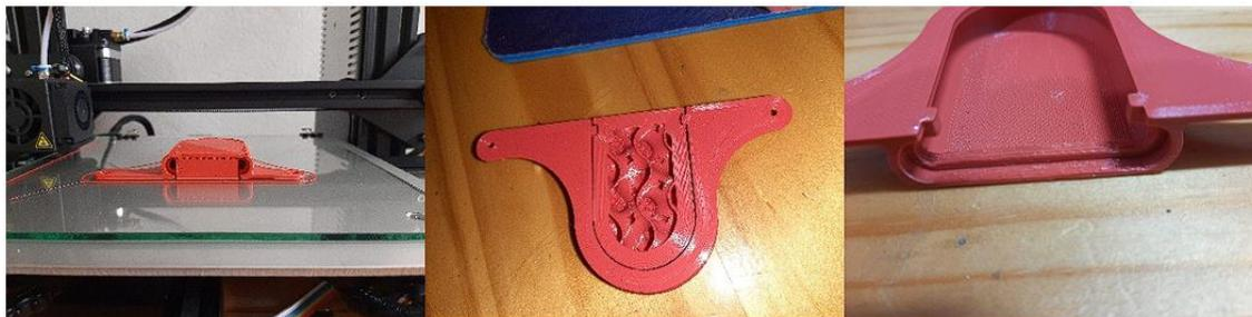
Figura 13 De izquierda a derecha: pieza impresa con soportes, vista inferior de los soportes de la pieza y pieza con soportes retirados.
