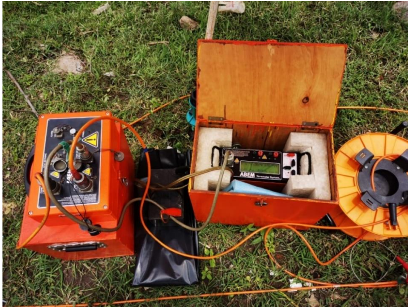
Figura 28: Materiales utilizados para la prospección geofísica, encontrándose de izquierda a derecha, unidad de conmutación, resistivímetro y carrete. Fuente: Elaboración propia.
