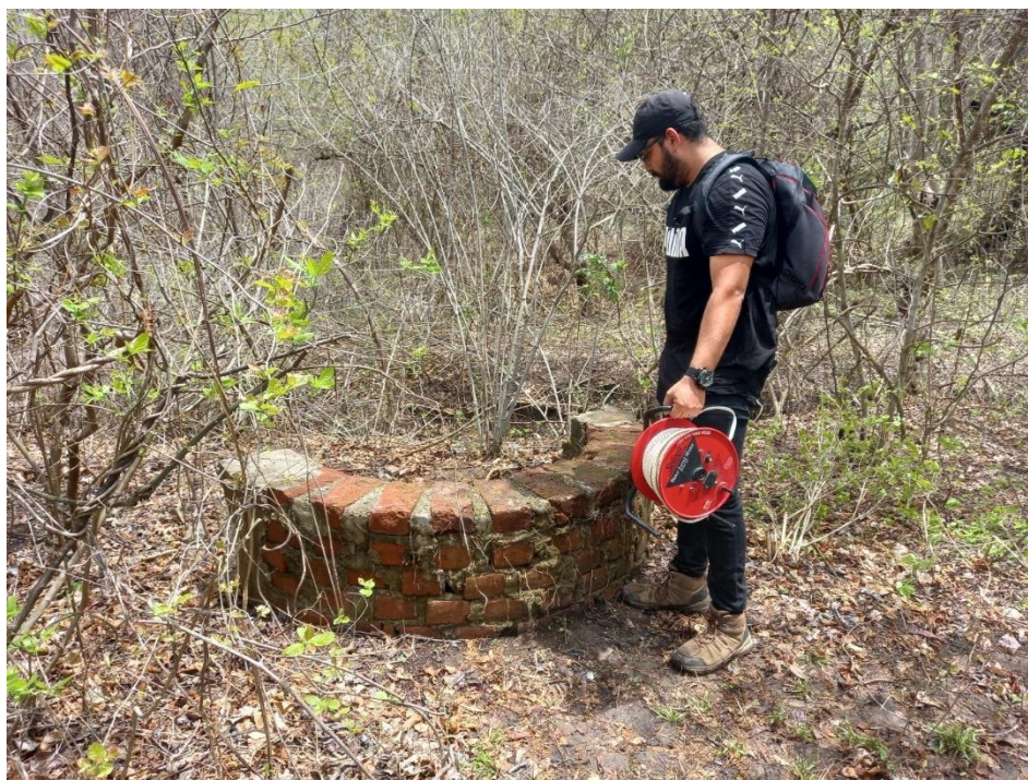
Campaña de ubicación de fuentes de agua en las inmediaciones del exbotadero a cielo abierto. Entre las fuentes de agua se encuentran pozos excavados, como el que se muestra en la imagen.
