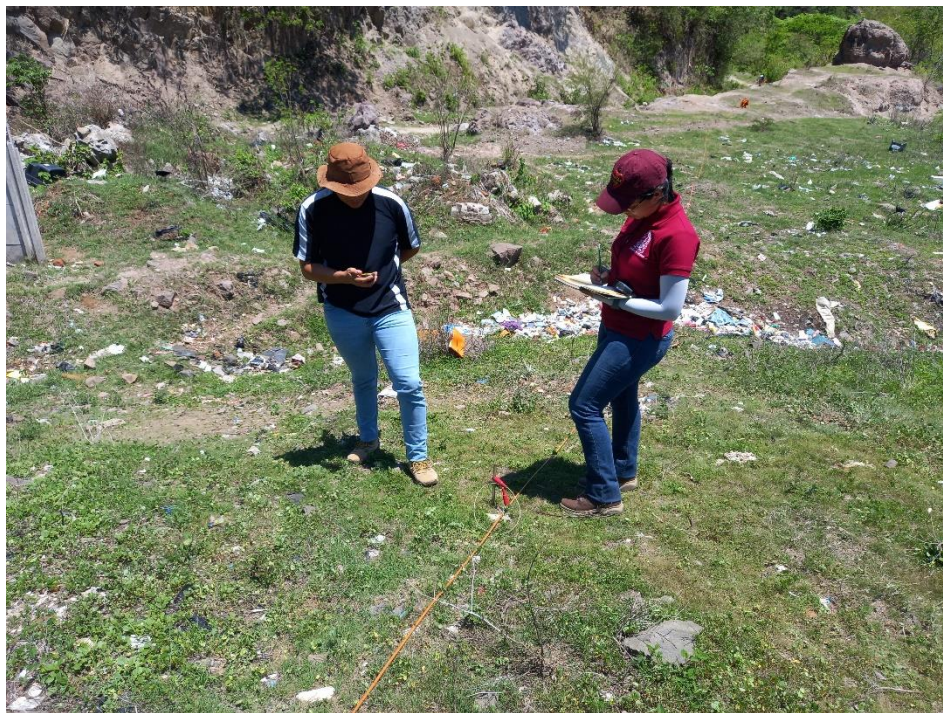
Toma de puntos de GPS a cada electrodo para ingreso de topografía a modelos de resistividad eléctrica generados.
