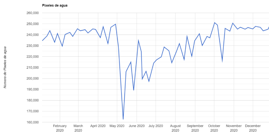
Fig. 55. Cantidad de pixeles de agua de embalse 15 de Septiembre durante el año 2020.
