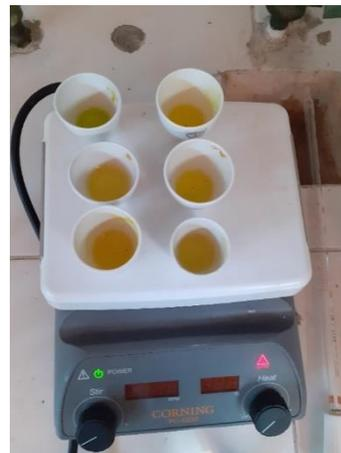
Figura N°20. Evaporación de ácido clorhídrico
