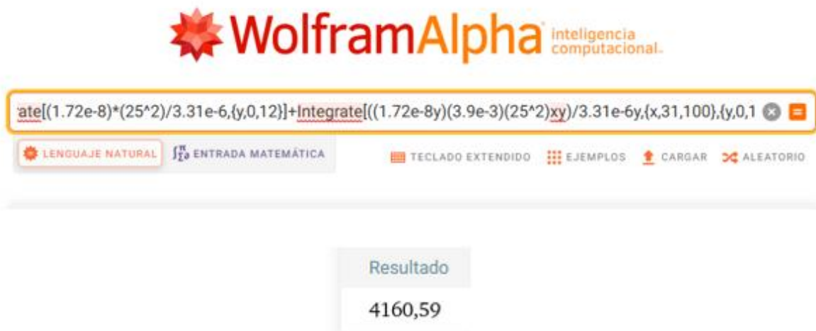
Ilustración 11::Utilizando software libre para calcular el valor de potencia disipada. Para una temperatura de 100°C.
