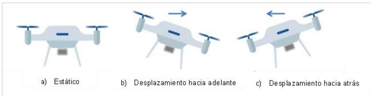
Figura 21. Esquema de desplazamiento del UAV utilizando inclinación a) ningún desplazamiento b) desplazamiento hacia adelante tras la inclinación y c) desplazamiento hacia atrás tras inclinación. Obtenido de (Aubert, 2022).
