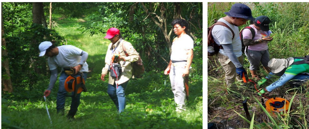
Figura 27. Fotografías obtenidas durante la adquisición de datos de potencial espontáneo en San Miguel, El Salvador (Fuente: Benítez, 2022).
