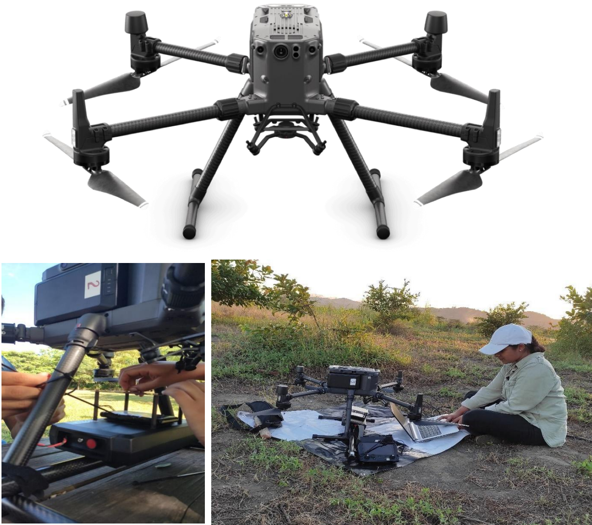
Figura 29. Aeronave industrial Matrice RTK 300 con avanzado controlador de vuelo, sistema de detección y posicionamiento en seis direcciones (DJI Enterprise, 2020). Las fotografías inferiores muestran el acoplamiento del MagDrone R3 a la Aeronave Matrice 300 RTK en su tren de aterrizaje para la adquisición de datos (Fuente: Ventura, 2022).
