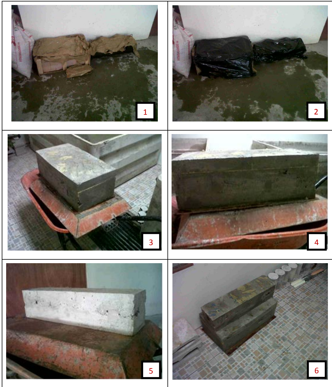
Figura 4.5: PROCESO DE CURADO DE VIGAS Y CUBOS
