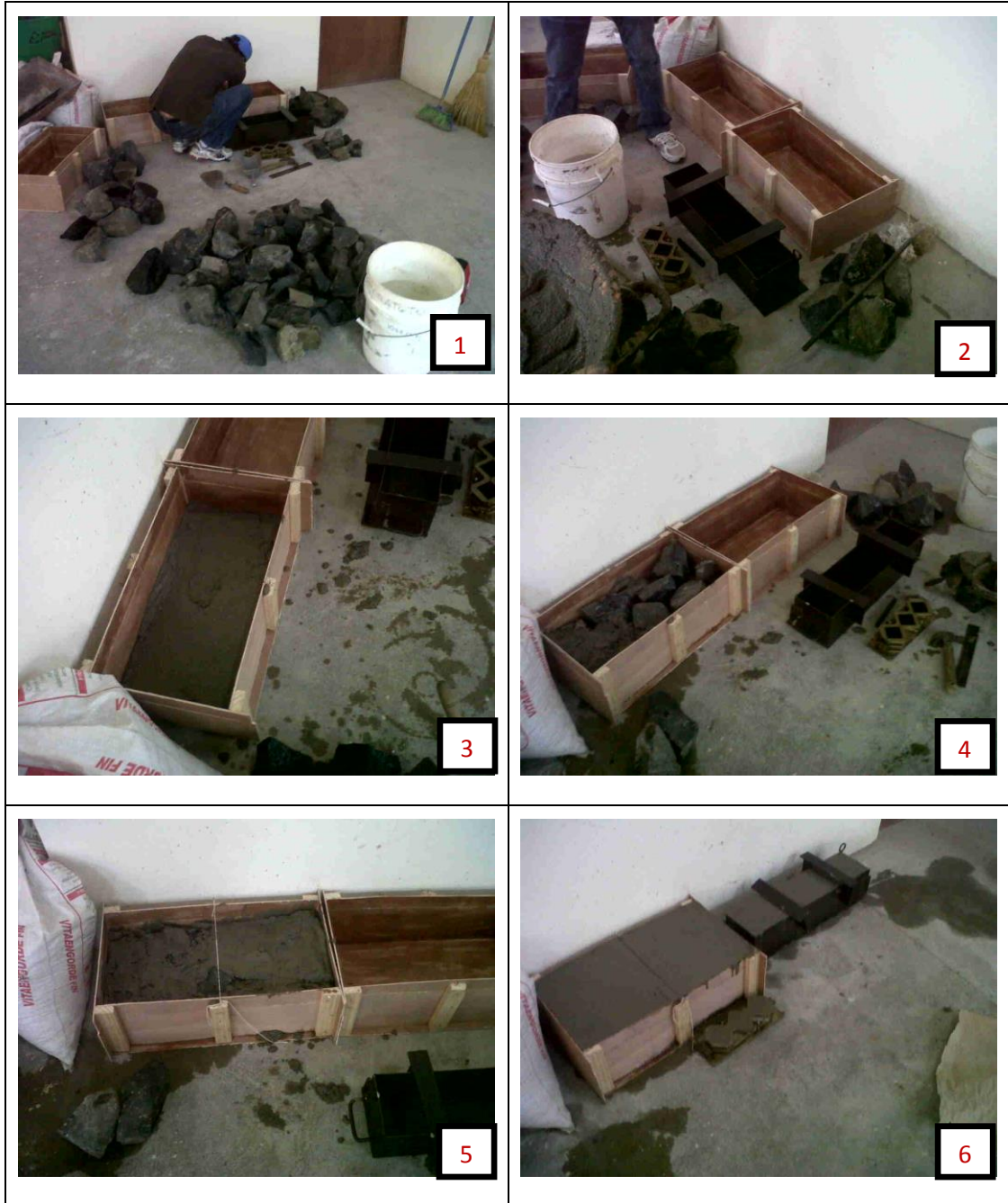
Figura 4.4: ELABORACION DE VIGAS Y CUBOS
