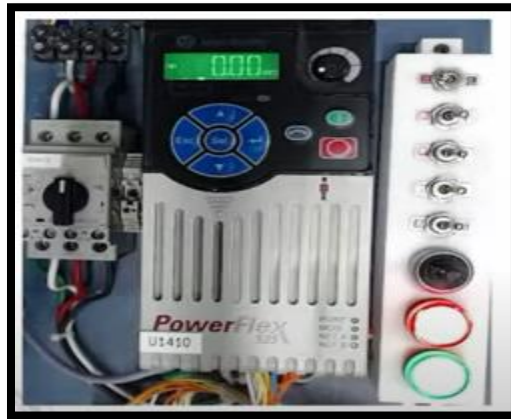
Figura 79 Representación de variador con su panel de control
