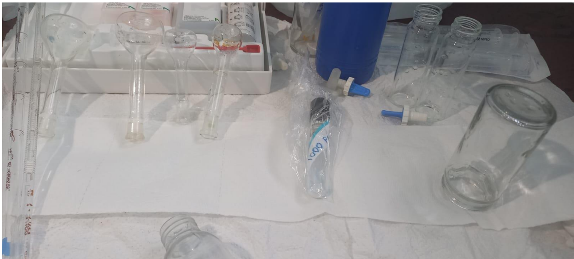
Figura N°21. Equipo kit MQuant® Arsenic Test 1.17917.0001 para proceder al analisis de las muestras.
