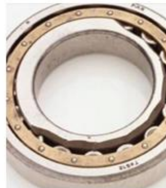
Fracturas en rebordes.
