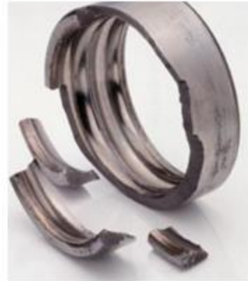
Fracturas en el aro exterior.
