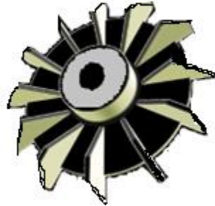
Figura 3.25. Ventilador dañado aspas rotas. 52
