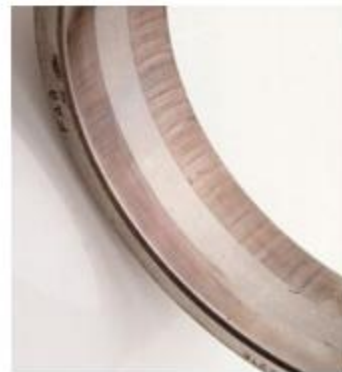
Paso de corriente eléctrica.
