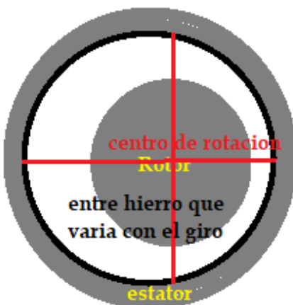
Figura 3.14. Forma de producirse la excentricidad estática – dinámica. 39
