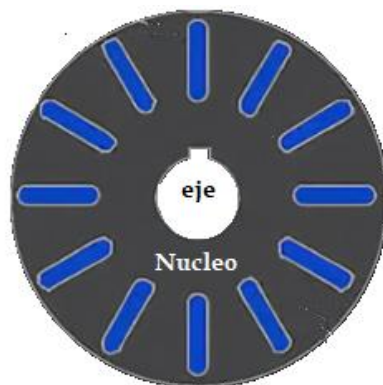
Figura 3.15. Sección transversal del rotor del motor. 40
