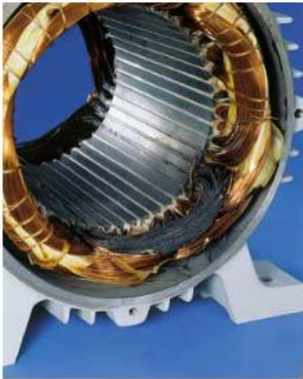
Bobina en corto circuito.
