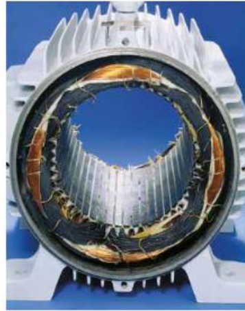
Fallo de la fase en conexión estrella.
