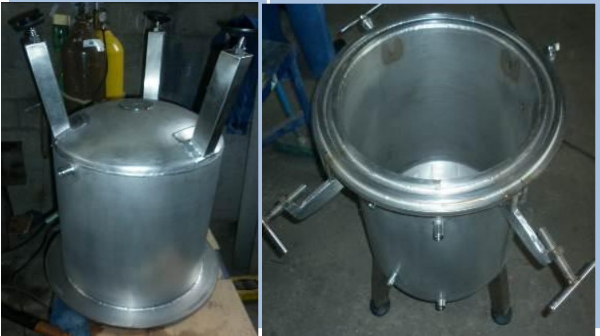
Figura. 3.10. Soldadura de casco cilíndrico, patas y accesorios para fijación
