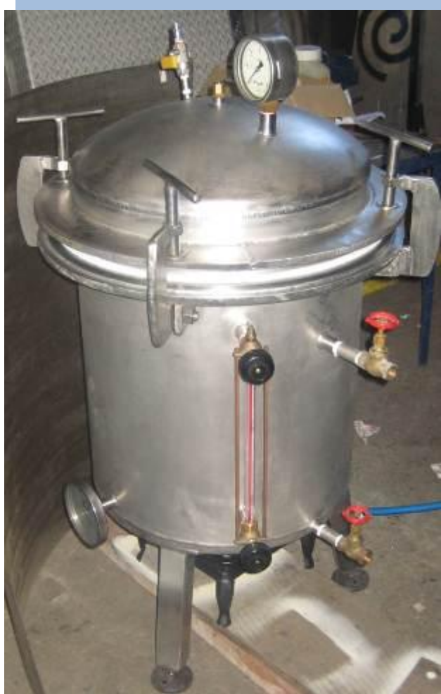
Figura. 3.11. Autoclave soldado y con sus accesorios roscados.
