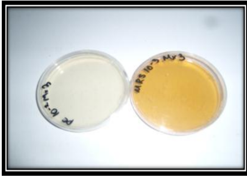
Fig. 4.10. Muestras microbiológicas de frijol esterilizado después de incubación. Ausencia de crecimiento de microorganismos.
