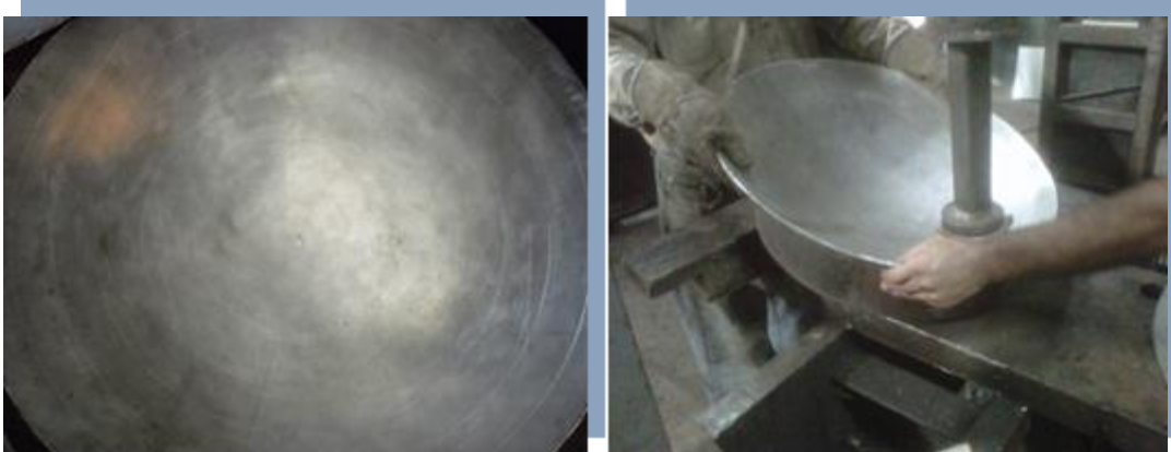
Figura 3.4. Trazos en la lámina y forjado de fondos
