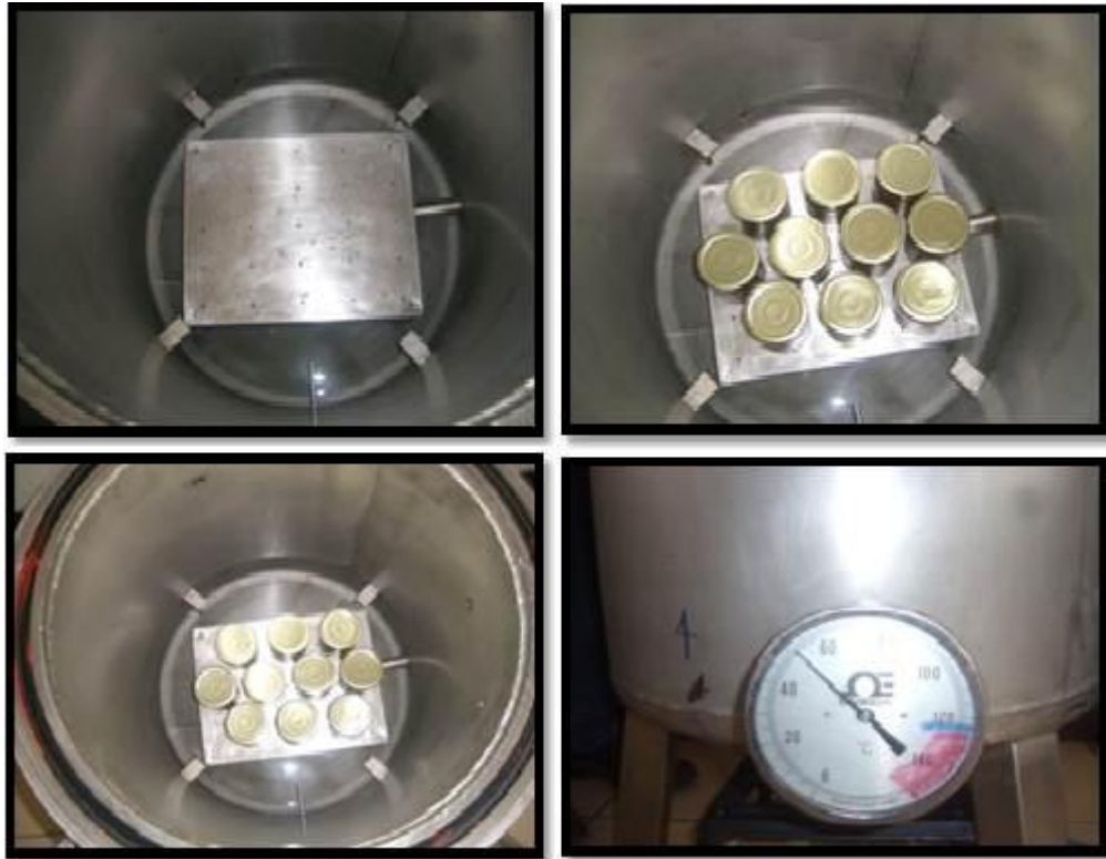
Figura 4.8. Procedimiento de esterilizado
