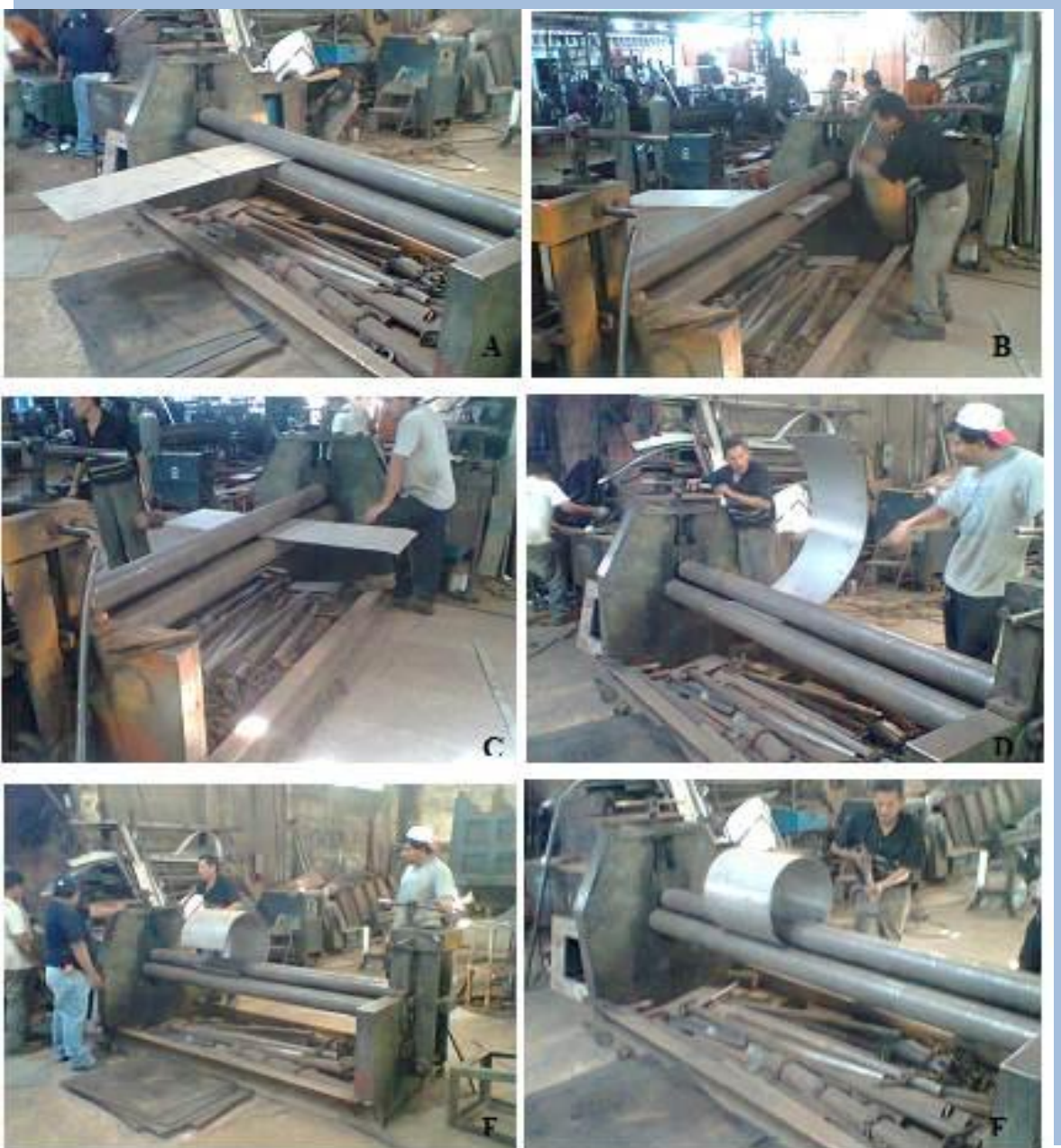
Figura.3.6. A. Ingreso de la lámina a la roladora. B y C. Pre-curvado. D. Primera pasada. E y F. Segunda pasada.
