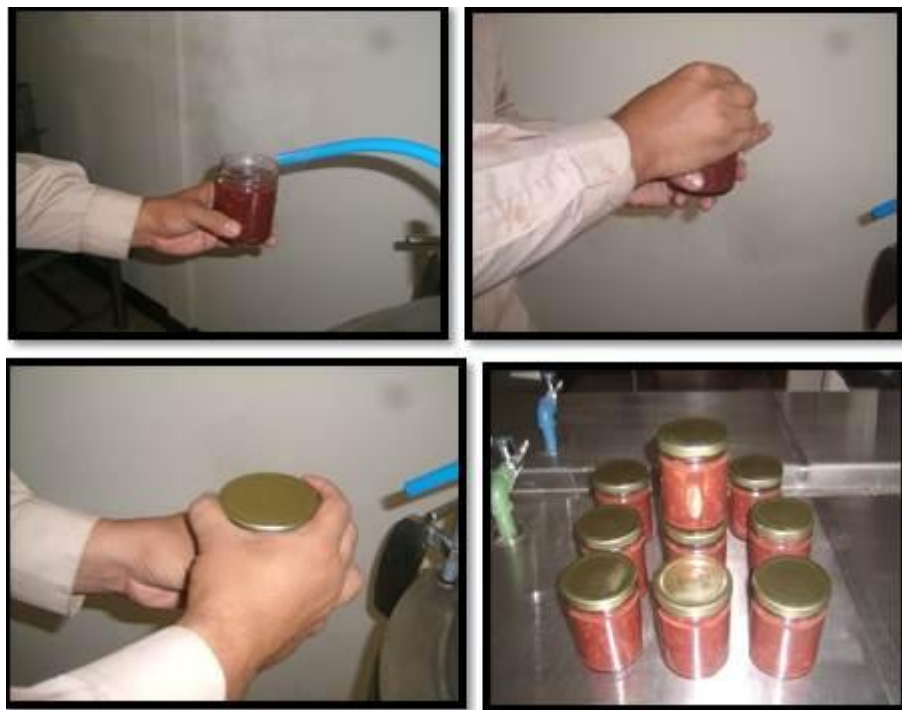
Figura. 4.7. Procedimiento de eliminado de aire a frascos con producto.
