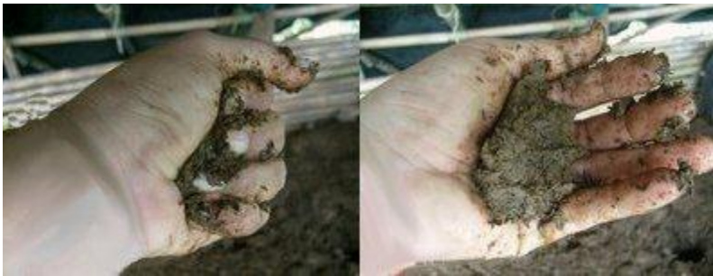
Figura N° 12: Método del puño para medir humedad en sustrato
