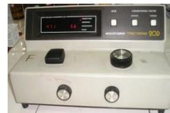
7. Leer la absorbancia de cada tubo en el espectrofotómetro Uv/visible a una longitud de onda de 276 nm.
