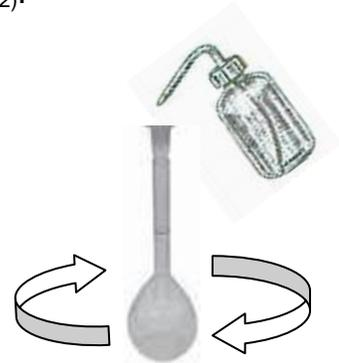
3. Agregar 30 mL de agua destilada, agitar hasta disolver, aforar a volumen y homogenizar.
