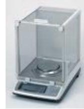
9. Pesar el papel filtro, conteniendo la biomasa en balanza analítica. Por diferencia de peso determinar la biomasa.
