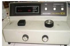
5. Llevar a temperatura ambiente y leer en el espectrómetro uv-visible a una longitud de onda de 490 nm.
