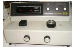
9. Determinar la absorbancia en espectrofotómetro uv/visible, previamente calibrado a 490 nm. Los valores obtenidos interpolarlos en una curva tipo de glucosa de 0 a 100  $\mu\text{g/mL}$ ; elaborada en tabla N°1.
