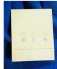
5. Depositar 20  $\mu\text{L}$  de muestra sobre una placa cromatográfica del filtrado obtenido en determinación de biomasa y 20  $\mu\text{L}$  del Std de Ácido Glucónico. Intercalar muestra y estándar a una distancia de 10 mm para cada aplicación.
