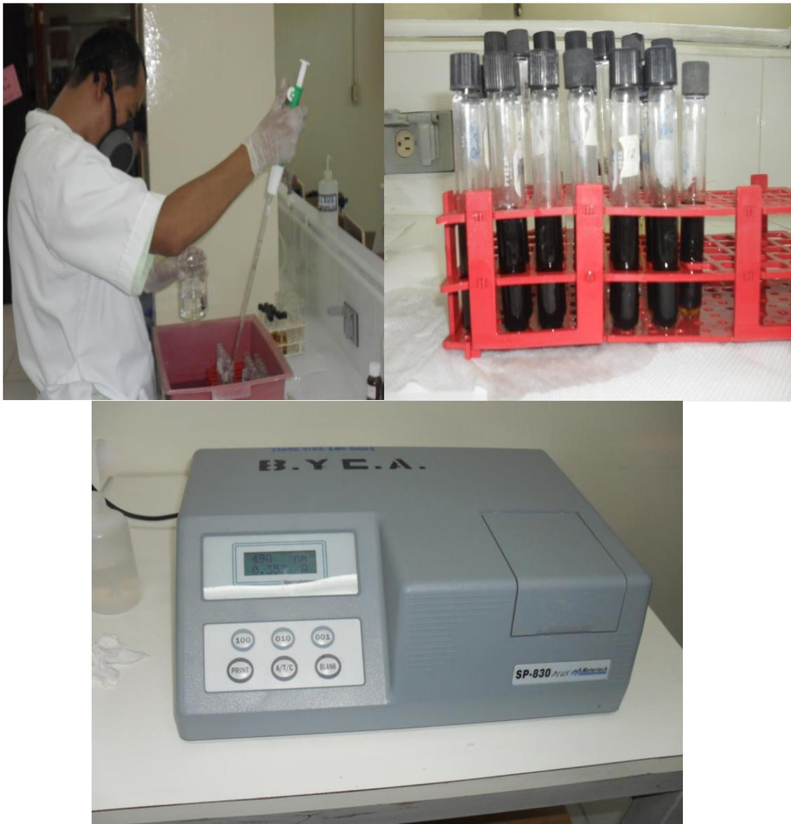
Figura N° 28. Cuantificación de azúcares totales por el método fenol-sulfúrico en muestras del fermento
