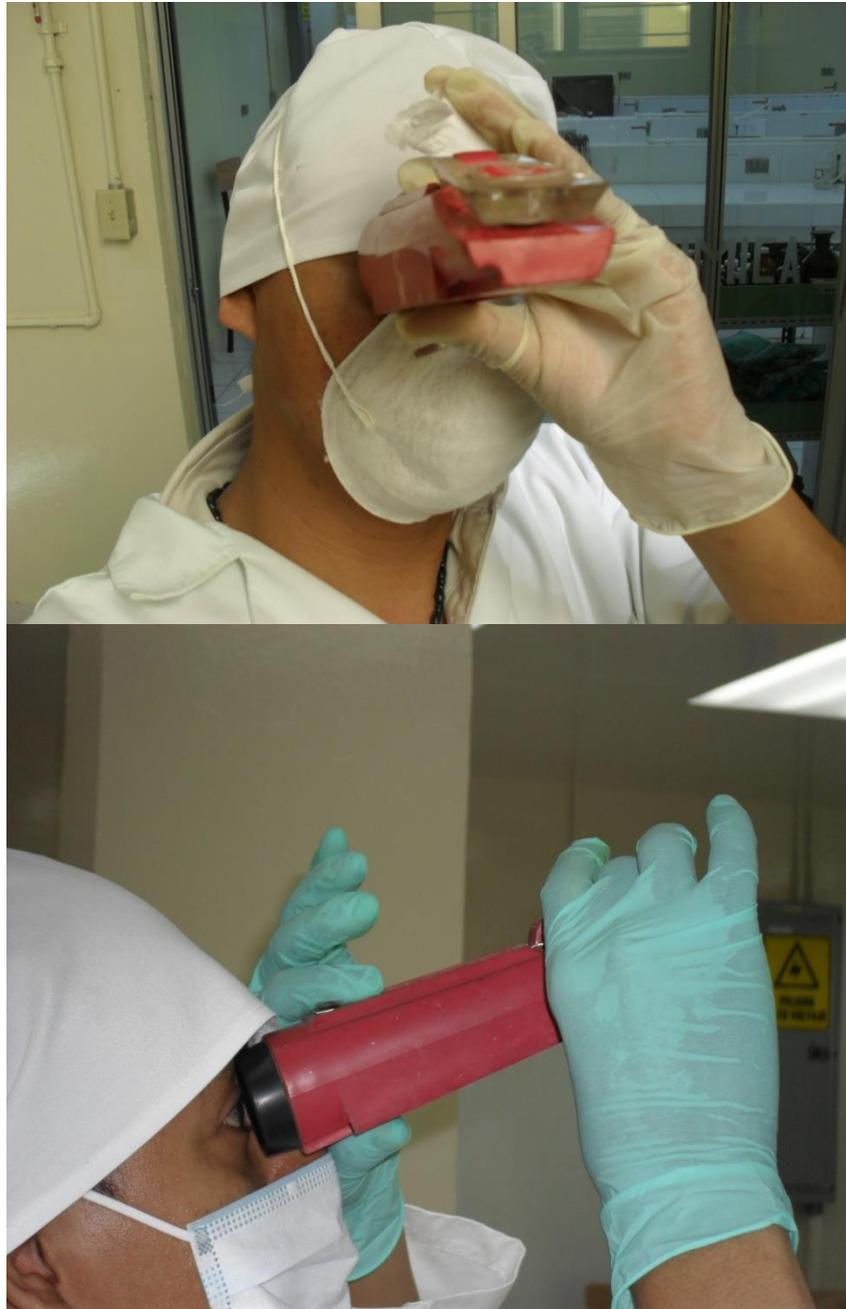
Figura N° 27. Medición de grados °Brix en muestras del fermento
