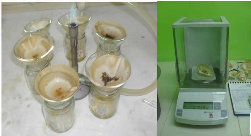
Figura N° 26. Proceso de obtención de la biomasa (filtración por gravedad)
