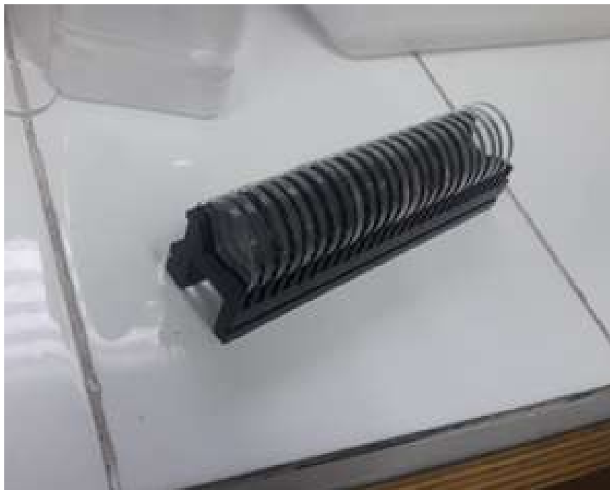
Figura 3.3: Cassete de medición con capacidad de 25 muestras.
