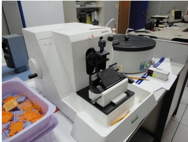
Figura N° 34. Micrótopo rotatorio (equipo para realizar cortes histológicos) ubicado en el Laboratorio de Patología, 3er nivel del edificio de CENSALUD, Universidad de El Salvador.
