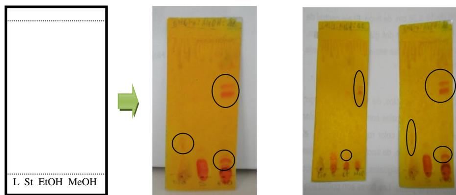
Figura N° 43. Cromatografía en capa fina. Evidencia positiva (manchas anaranjadas en círculo) de la presencia de alcaloides en el extracto acuoso y en el extracto acuoso liofilizado (regenerado con agua destilada, metanol y etanol) de las flores de *Erythrina berteroana* (pito). Fase móvil utilizada  $\text{CHCl}_3$ : MeOH: Acetona
