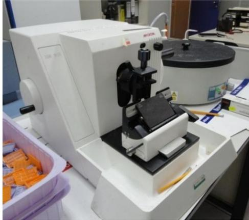
Figura N° 71. Micrótopo rotatorio (equipo para realizar cortes histológicos) ubicado en el Laboratorio de Patología, 3er nivel del edificio de CENSALUD, Universidad de El Salvador.
