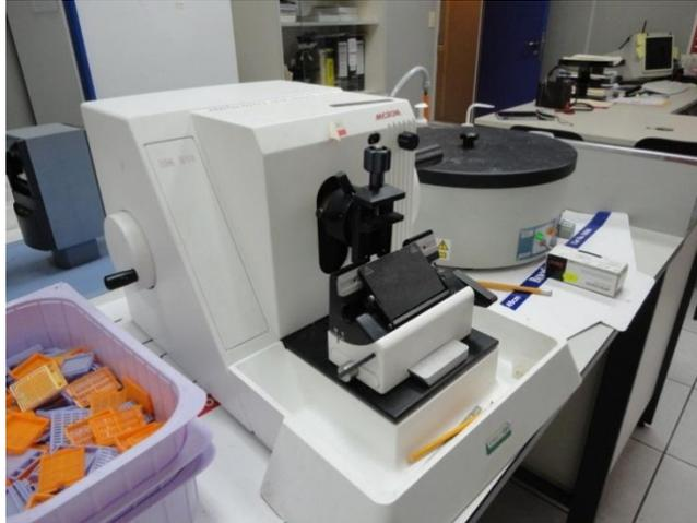
Figura N° 57. Equipo para realizar la microtomía u obtención de los cortes.
