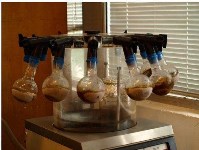
Figura N° 33. Aparato Liofilizador (Christ Alpha 2-4, LDC-1M)
