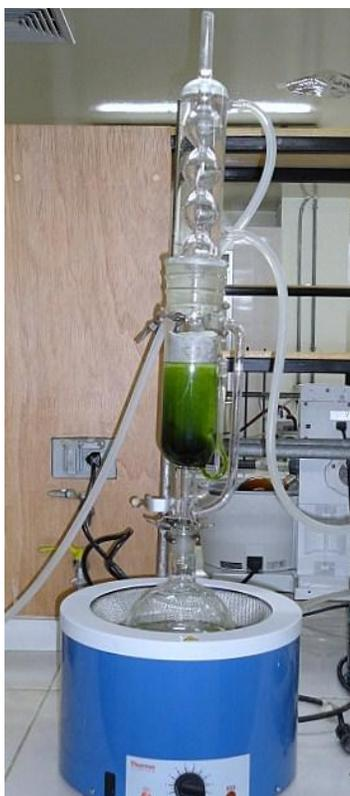
Figura N° 29. Aparato Soxhlet
