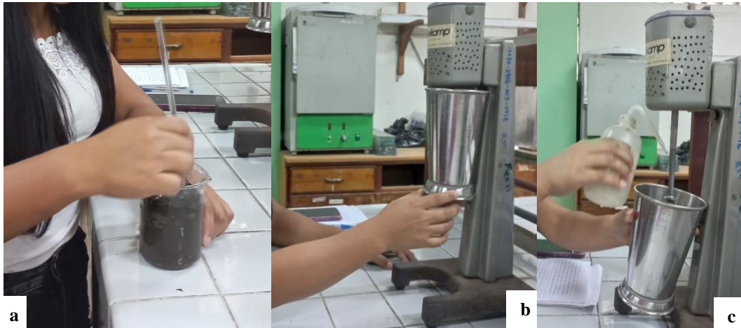
Figura 9. Determinación de la textura del suelo por el método de Bouyoucos. Agitado de muestra con agitador de vidrio (a), muestra de suelo en agitador metálico (b), adicionando agua destilada al agitador metálico después de la disolución de las partículas (c).
