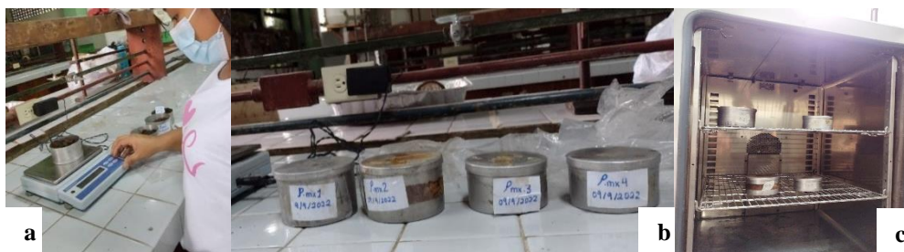
Figura 11. Determinación de la Densidad Aparente en Laboratorio. Peso de la muestra húmeda más caja (a). Muestras rotuladas (b), muestras colocadas en estufa a 105°C (a).
