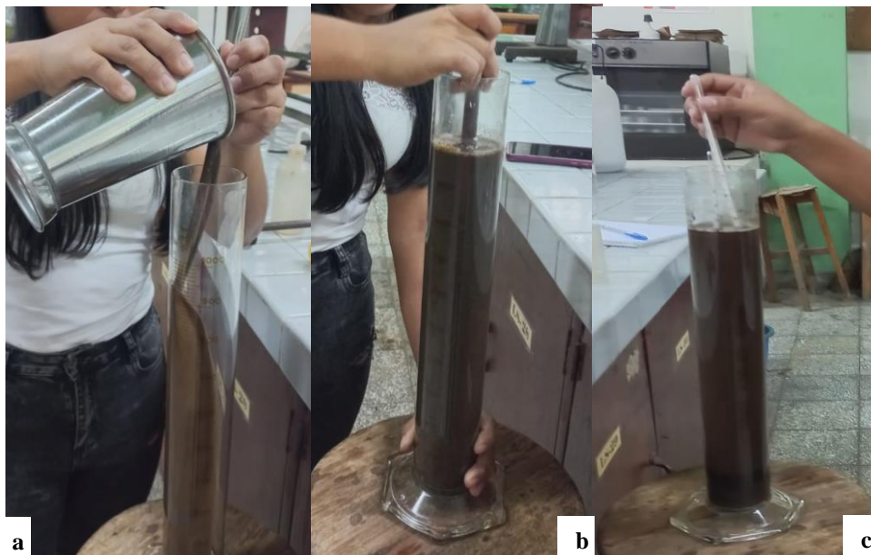
Figura 10. Determinación de la textura del suelo por el método de Bouyoucos. Incorporación de la muestra por sedimentación a probeta (a), Agitado de muestra en probeta (b), lecturas con termómetro (b).
