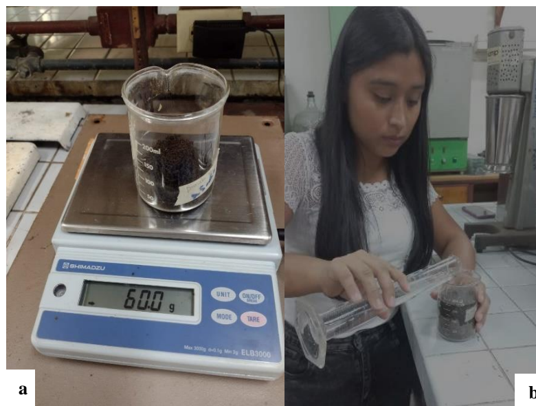
Figura 8. Determinación de la textura del suelo por el método de Bouyoucos. Peso de muestra de suelo tamizada (a), incorporación de la solución hexametáfosfato de sodio al beaker con la muestra (b).
