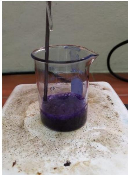
*Figura 44.* Adicion del indicador a la muestra.
