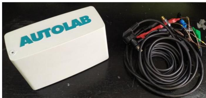
Figura 3. Potenciostato Metrohm Autolab PGSTAT101, utilizado en este trabajo.
