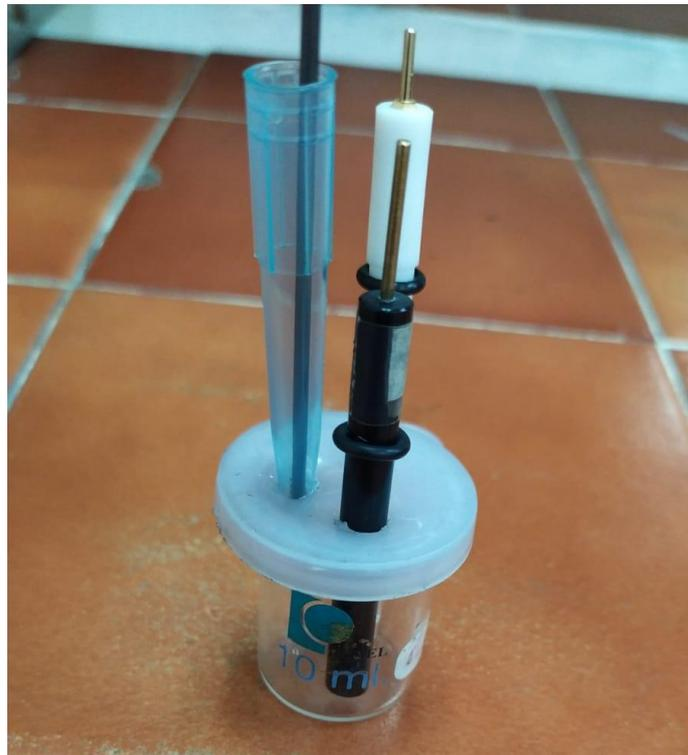
*Figura 29.* Sistema de celda y 3 electrodos utilizado para las mediciones.
