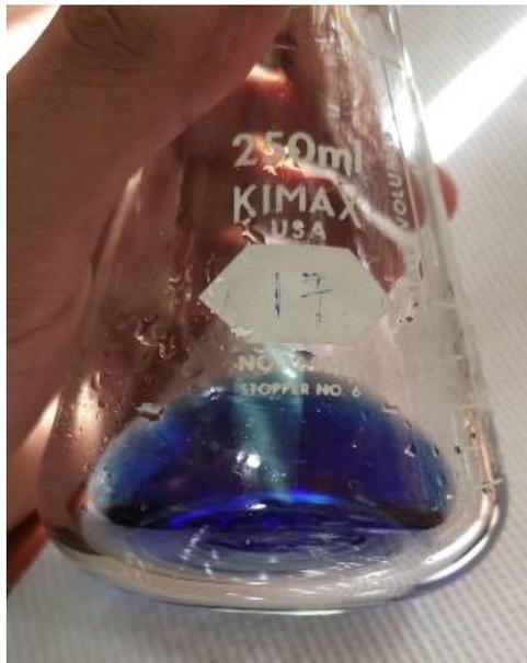
*Figura 42.* Punto final de la titulacion de cobre con EDTA.
