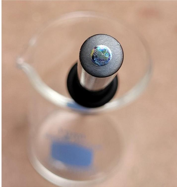
*Figura 28.* Deposito de Oxido de Cobre (II) sobre la superficie del electrodo de carbono vitreo.
