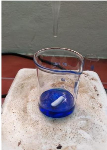
*Figura 43.* Disolucion de Fehling A + B.
