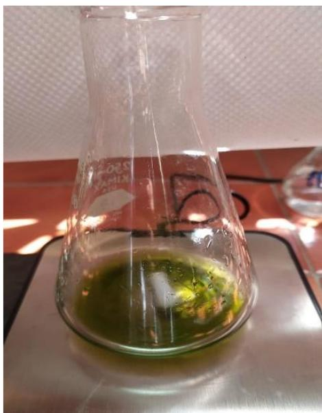
*Figura 40.* Punto de la reacción en que se torna verde claro la disolución.
