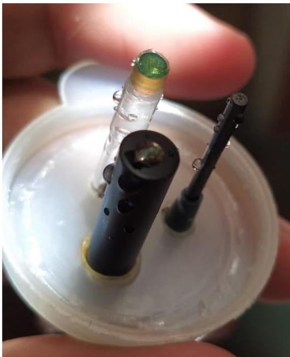
*Figura 36.* Sistema de 3 electrodos con deposito de Oxido de cobre (II).
