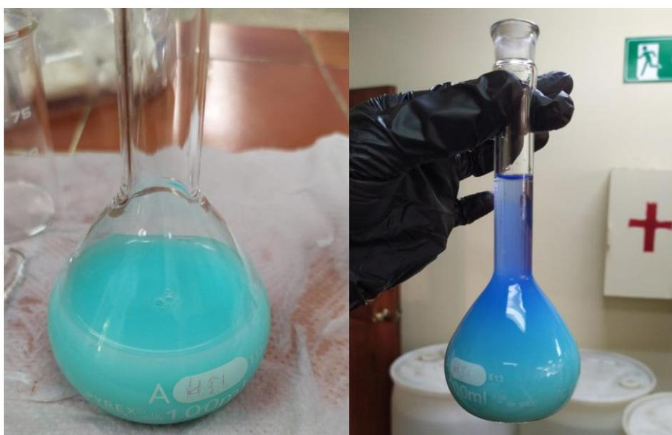
*Figura 33.* Precipitado de la solución de cobre antes de formar el complejo con el amoníaco.
