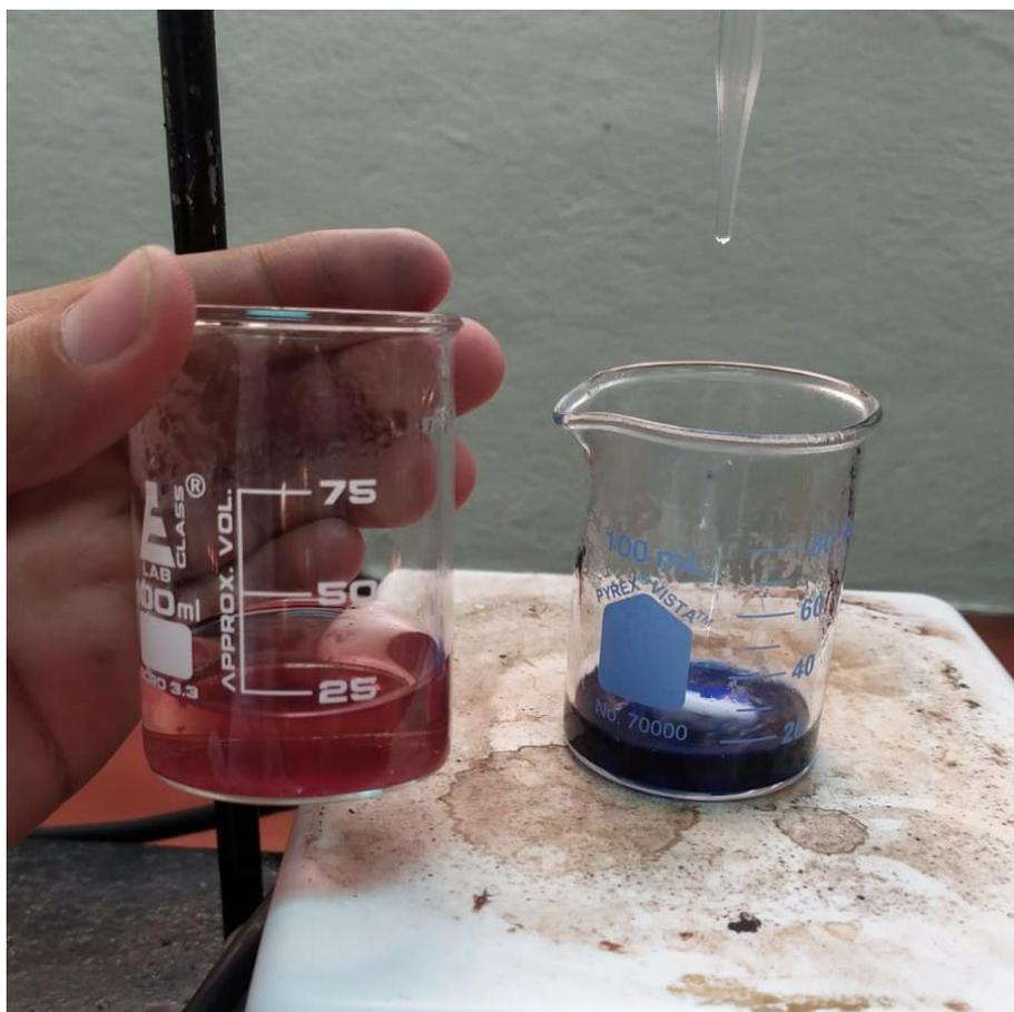
*Figura 46.* Comparativa entre el punto inicial y el punto final de la titulación de la muestra de miel.
