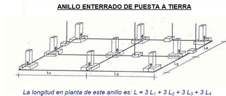
Figura 5.8: Anillo enterrado de puesta a tierra
