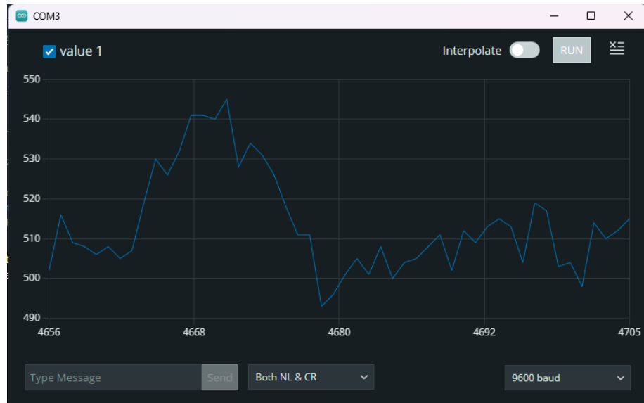
Figura 3.12: Lectura PPG ruidosa con Sensor IDUINO genérico. Elaboración propia.
