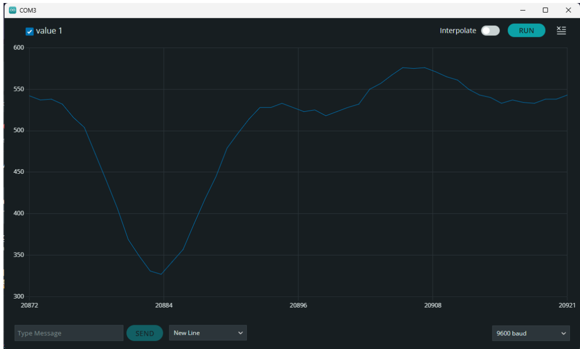
Figura 4.9: Señal PPG invertida obtenida en el monitor serial por medio del complemento.
