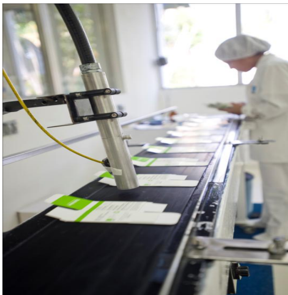
Figura N° 27 Maquina codificadora de material de empaque.
