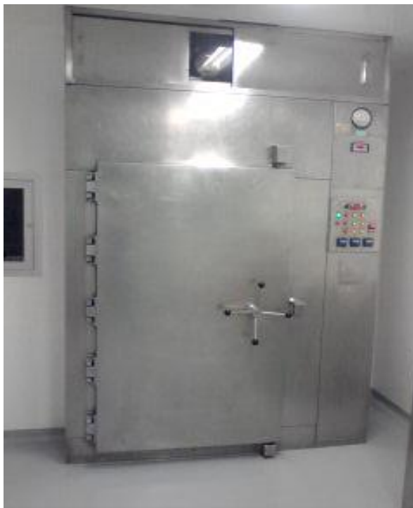
Figura N° 23 Estufa de esterilización (calor seco) ubicada en el área de esterilización de inyectables.
