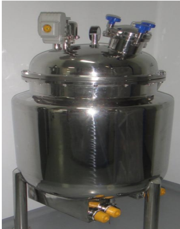
Figura N° 26 Tanque de acero inoxidable de doble chaqueta con capacidad 250 L.
