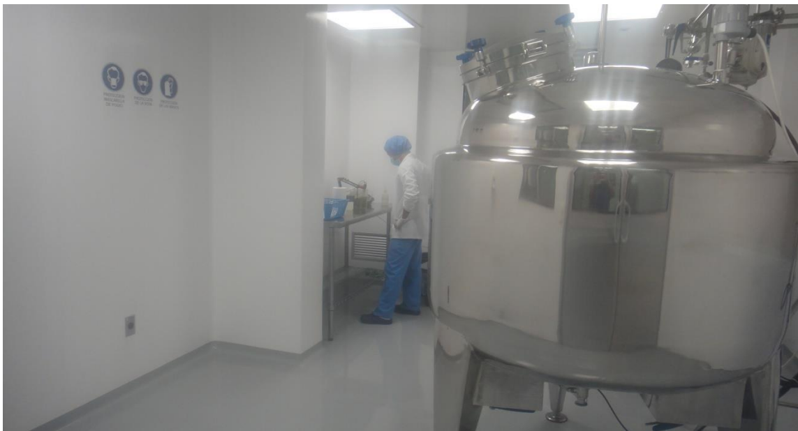
Figura N° 22 Tanque de acero inoxidable de doble chaqueta con capacidad de 750L.
