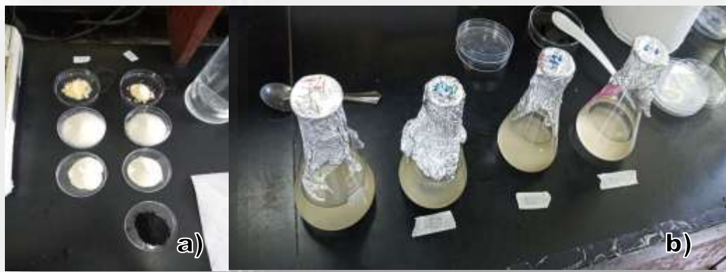
Figura A-4. Formulación de los medios de cultivo en orden de izquierda a derecha; (a) calculo y pesaje de cada elemento a ser disuelto en el medio de cultivo Medios de cultivo y (b) (T1, T2, T3, T4) con diferentes dosis de reguladores de crecimiento, en etapa previa a la adición de agar y carbón activado.
