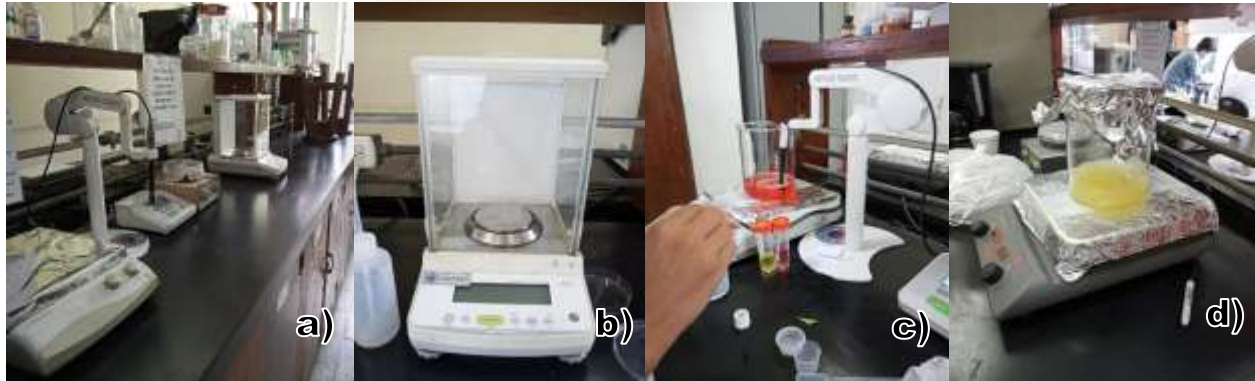
Figura A-3. Laboratorio de tejidos vegetales orden de izquierda a derecha; (a) área de preparación de medios de cultivo, (b) balanza analítica, (c) Ph-metro y (d) Hotplate.
