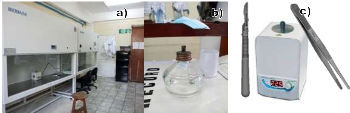
Figura A-2. Laboratorio de tejidos vegetales orden de izquierda a derecha; (a) Cámaras de flujo laminar y sala de preparación de medios de cultivo, (b) mechero de alcohol 90^\circ , (c) bisturí y esterilizador de perlas para pinzas.
