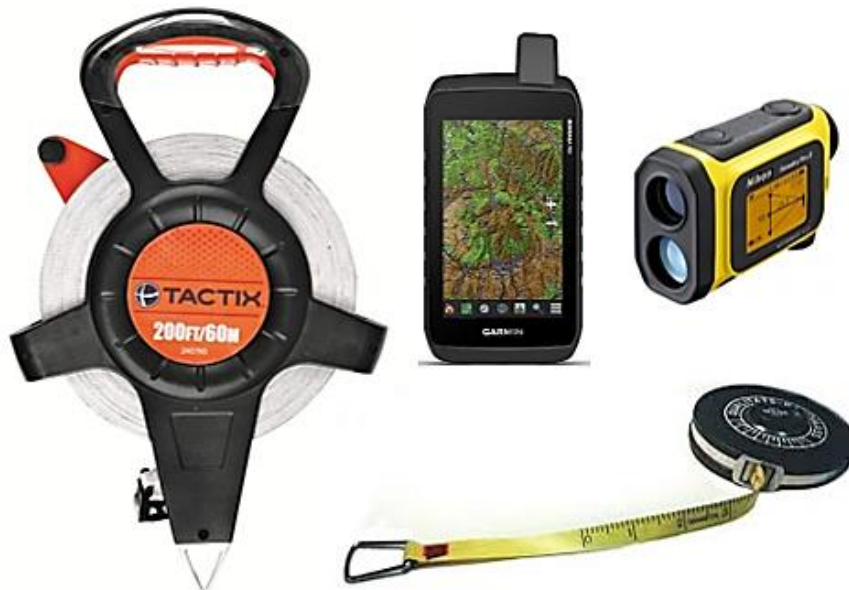
Figura 5. Equipo utilizado para el levantamiento de datos en campo (cinta métrica, GPS, hipsómetro láser y cinta diamétrica).
