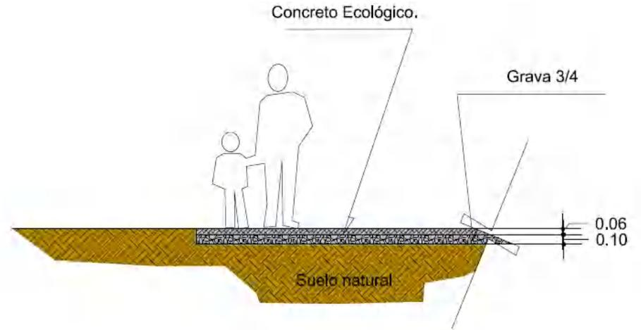
Detalle esquemático 1: concreto ecológico en senderos
