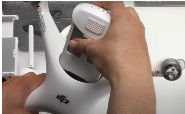
Figura 122 - Instalación de batería del dron
