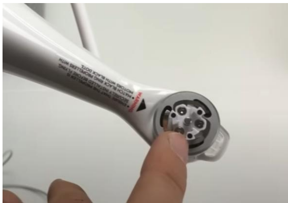
Figura 120 - Hélice de dron con marca negra
