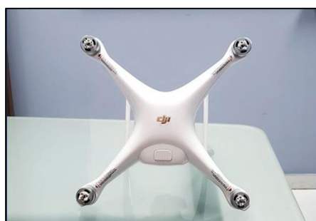
Figura 91 - IMU, Inclinación hacia atrás
