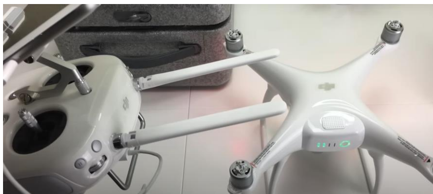
Figura 124 - Forma correcta de colocación de antenas
