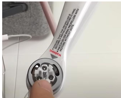
Figura 121 - Hélice de dron con marca plateada
