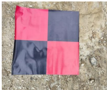
Figura 127 - Punto de control fotogramétrico
