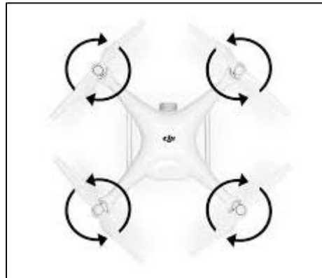
Figura 58 - Configuración de hélices de un dron
