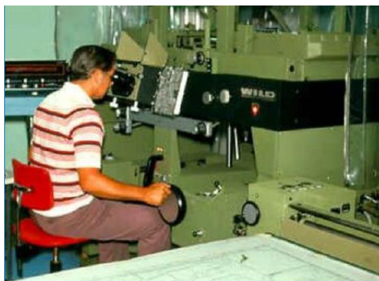
Figura 41 - Restituidor analógico Wild
