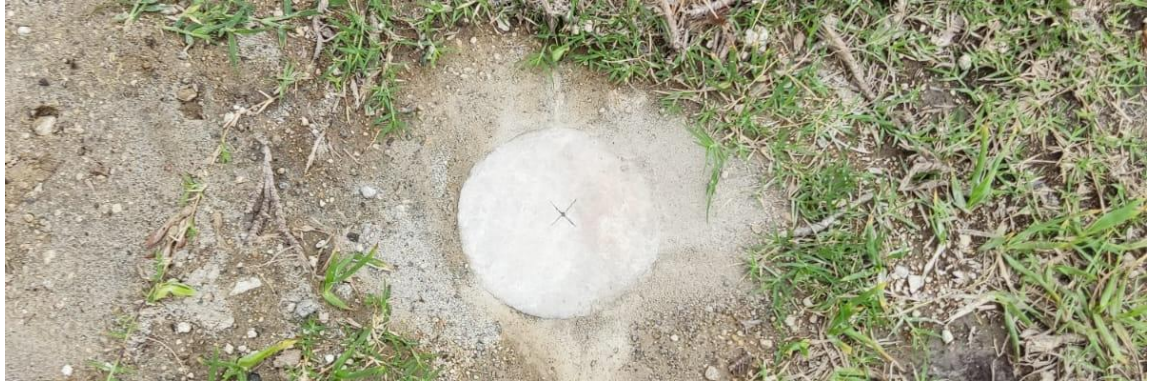
Figura 138 - Vértice geodésico colocado "CAST"
