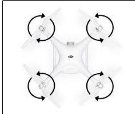
Figura 51 - Sentido del giro de las hélices de un dron
