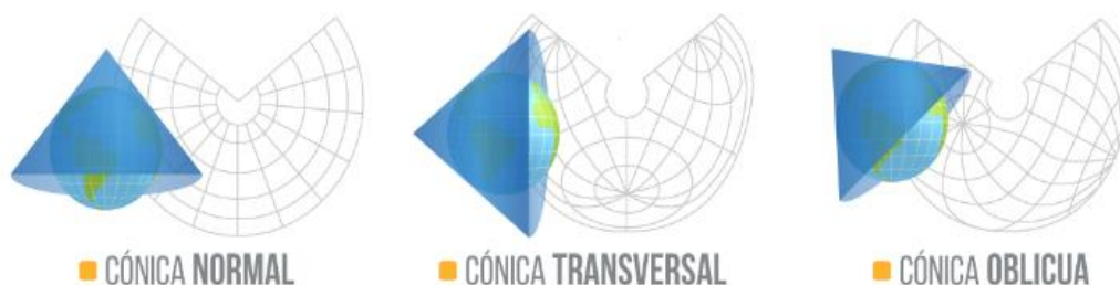
Figura 17 - Tipos de proyecciones cónicas.
