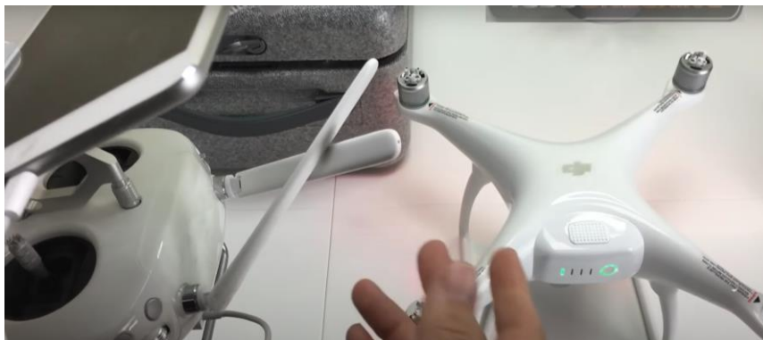
Figura 123 - Forma incorrecta de colocación de antenas
