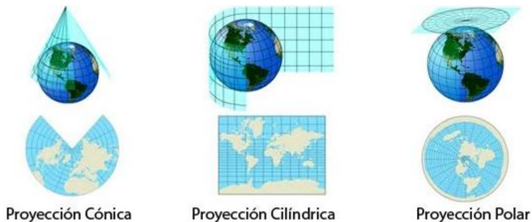
Figura 11 - Tipos de Proyecciones Cartográficas.
