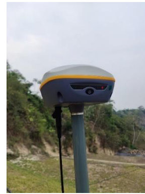
Figura 135 - Receptor Utilizado como base
