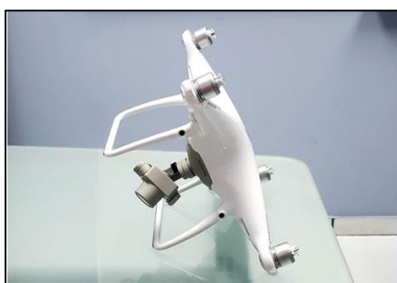
Figura 89 - IMU, Inclinación hacia la derecha
