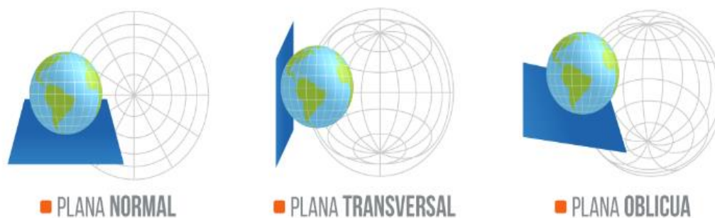
Figura 13 - Tipos de proyecciones planas.
