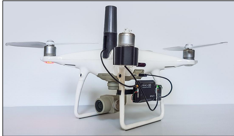
Figura 54 - Dron Phantom 4 Pro con sensor LIDAR
