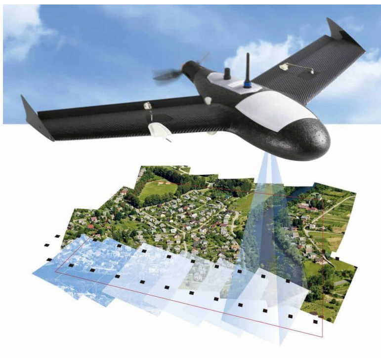
Figura 36 - Fotogrametría con dron de ala fija
